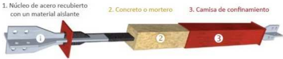
Figura 2.2. Esquema descriptivo del disipador BRB. Fuente: [59].
