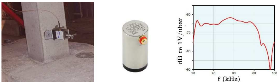
Figura 6.20. Fijación del sensor VS30-V y su curva de sensibilidad.
