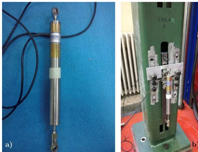
Figura 4.4. Transductor LVDT utilizado en el ensayo. a) Imagen del transductor LVDT. b) Colocación durante el ensayo cíclico.
