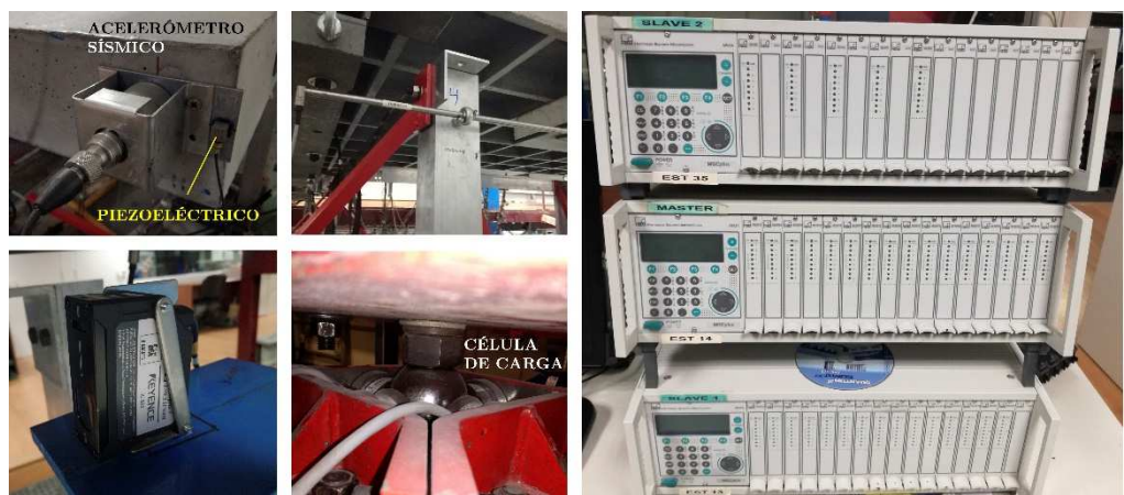
Figura 6.22. Instrumentación para medir la aceleración, el desplazamiento y la fuerza en el espécimen. De Izq. a Der.: Acelerómetro sísmico y piezoeléctrico Brüel&Kjaer , y sensor láser KEYENCE ; sensor LVDT HBM , y células de carga HBM ; equipo de adquisición MGC-Plus ( HBM ).
