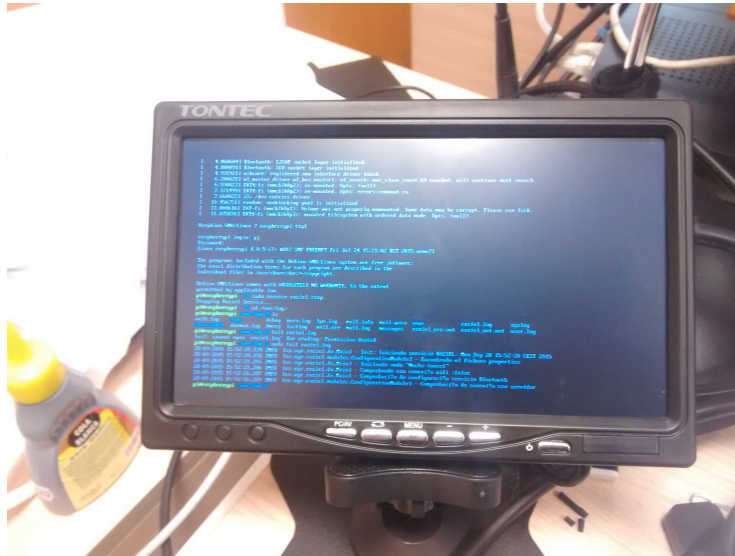
Figura 5.27 Pantalla externa conectado a la placa mediante la interfaz HDMI. Esta pantalla requiere de alimentación externa
