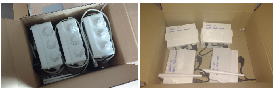
Figura 5.40 Transporte de los nodos de monitorización. Los nodos se pueden transportar tanto dentro de la caja estanca (para ser instalados ambos al mismo tiempo) como dentro del soporte para ser acoplados a cajas estancas ya instaladas.
