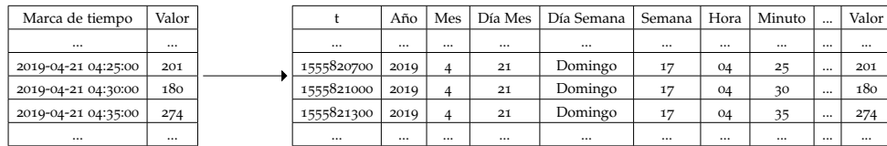
Figura 5.97 Preprocesamiento de series temporales para SVM, donde se convierte en el conjunto de datos unidimensional etiquetado, en un conjunto multidimensional que permite que extraer mejor los patrones de comportamiento de los distintos tipos de conjuntos de datos.
