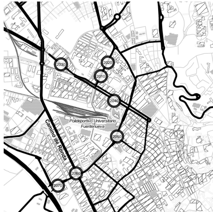
Figura 5.14 Ejemplo de red de nodos sensores desplegado en un entorno urbano.
