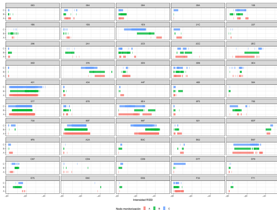
Figura 6.25 Comparativa de la intensidad RSSI entre distintos nodos capturando tráfico WiFi.
