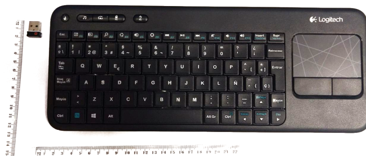
Figura 5.28 Teclado portátil empleado para la comunicación con el prototipo.
