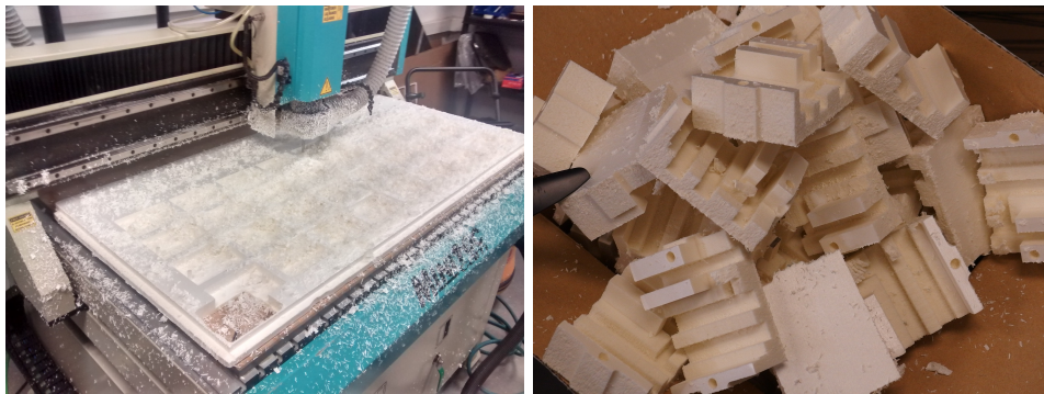
Figura 5.34 Proceso del fresado del soporte y aislante del prototipo.
