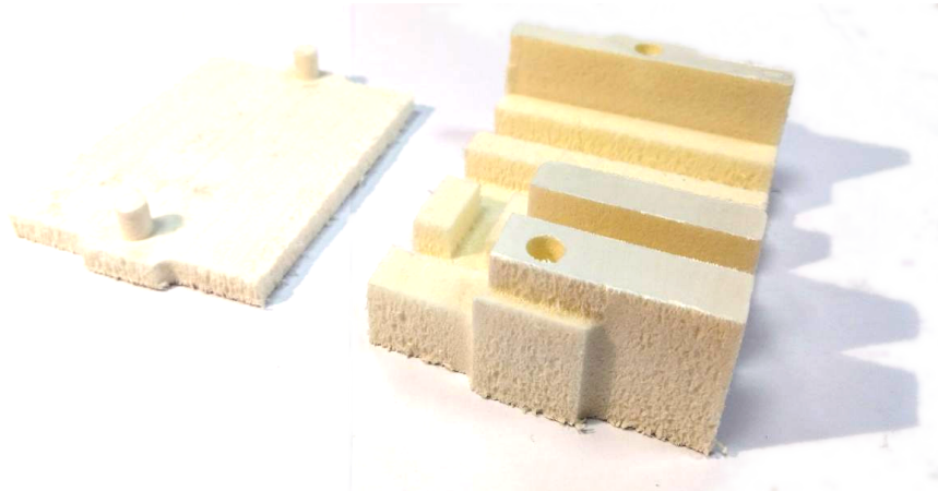
Figura 5.35 Fotografía del soporte y aislante de la placa, donde se emplazan los distintos elementos hardware del prototipo.
