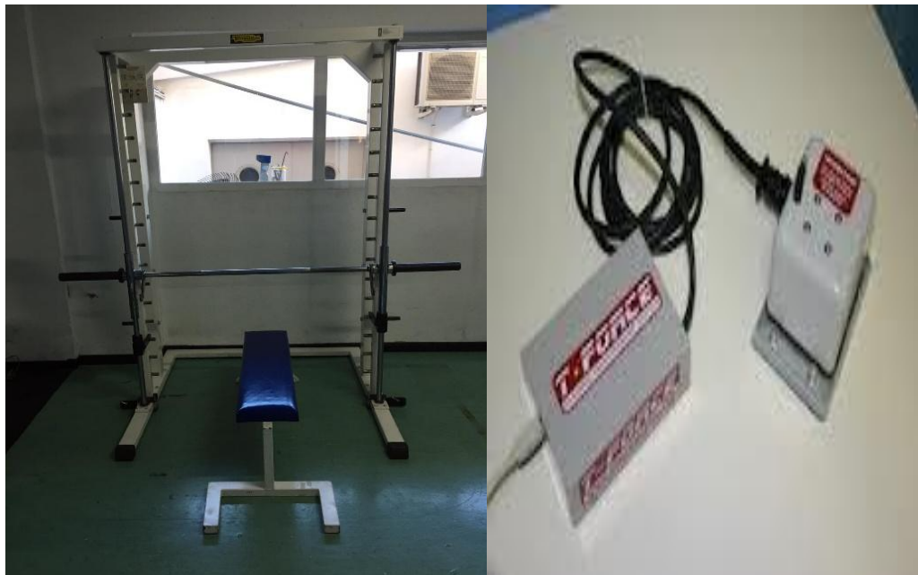
Figura 2. Máquina Smith y transductor lineal de velocidad utilizados en las mediciones.
