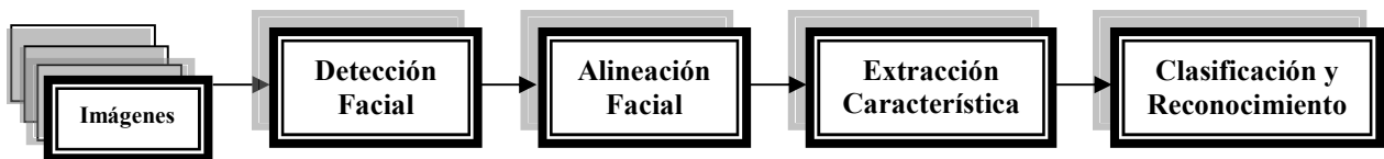
Figura 7.5: Arquitectura de un sistema convencional de identificación facial [Fuente: elaboración propia].
