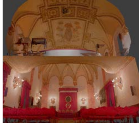
Figura 52. Posición de los escaneos en el interior del Paraninfo (perspectiva de la nube de puntos obtenida del levantamiento 3D). © Juan Francisco Reinoso Gordo (SMLab UGR).
