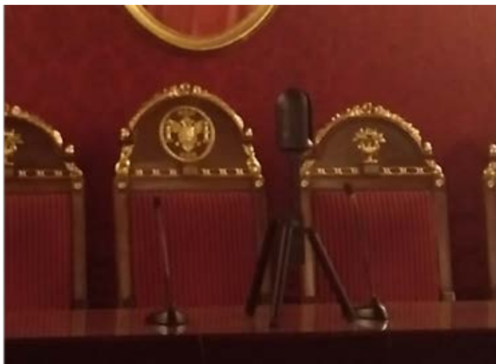
Figura 49. Escáner láser BLK360 capturando datos en el Paraninfo de la Facultad de Derecho
