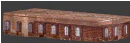
Figura 63. Perspectiva exterior de la nube de puntos 3D de la Secretaría. © Juan Francisco Reinoso Gordo (SMLab UGR).
