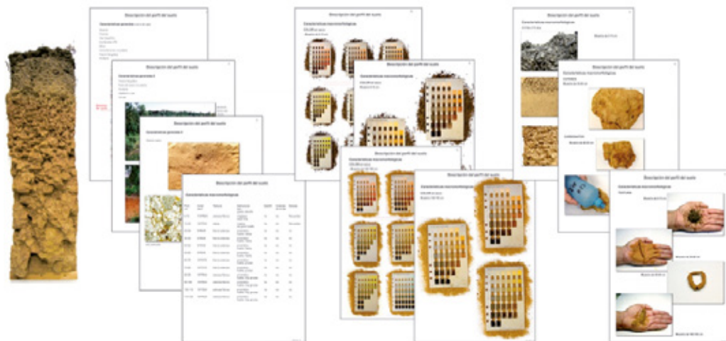
Figura 8. Monolito 12. Ejemplo de monolito interactivo para enseñar a describir el perfil y el reconocimiento de los horizontes.
