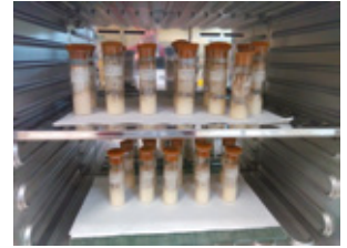
Fig. 2. Interior de uno de los incubadores que contienen los cultivos de Drosophila . Son viales cilíndricos de vidrio con un sustrato de papilla nutritiva y papel de filtro que sirve de soporte para las moscas.
