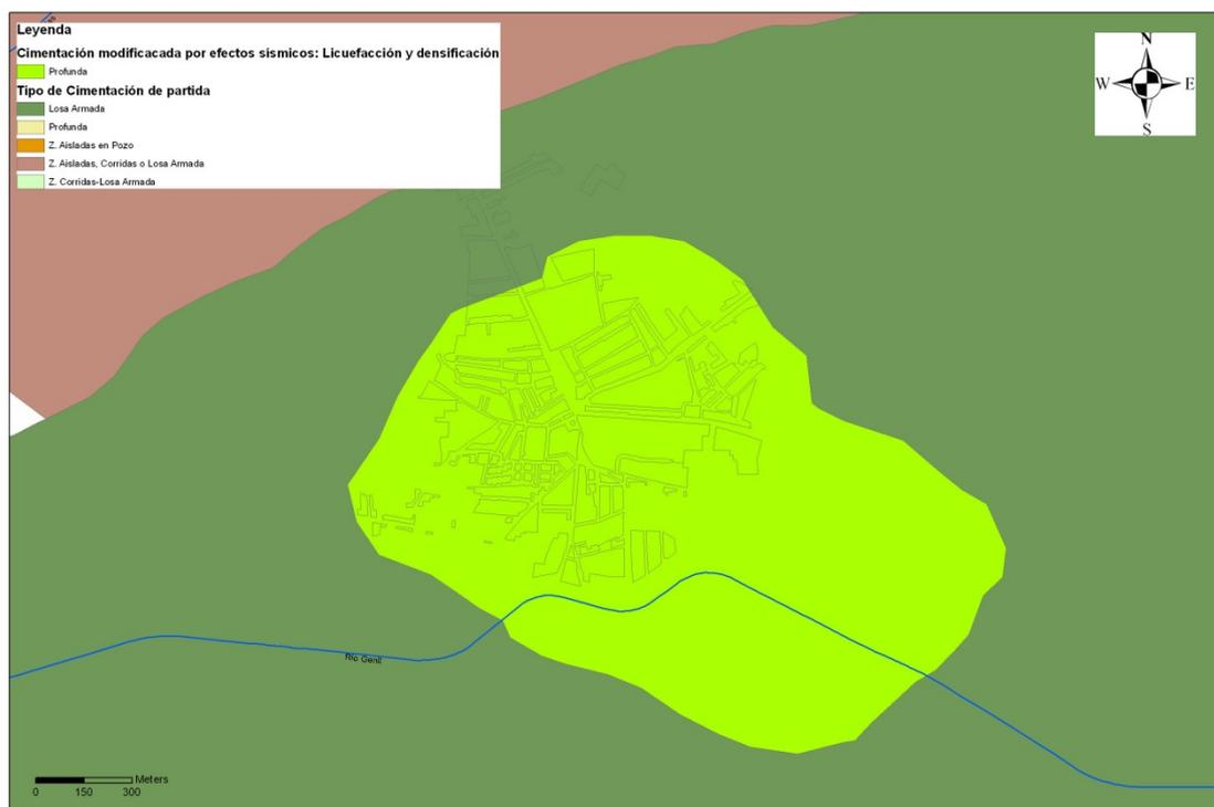
**Fig. 144.- Tipo de cimentación teniendo en cuenta los efectos sísmicos sobre el suelo en el sector de Fuente Vaqueros**
