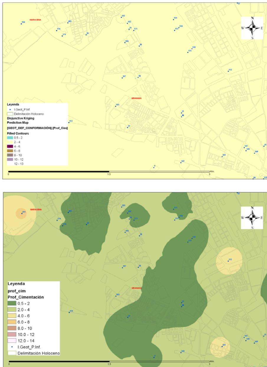
Fig. 110.- Comparación entre interpolación tipo “Disjunctive Kriging” (arriba) y tipo “IDW” (abajo) en el sector de Granada-La Chana
