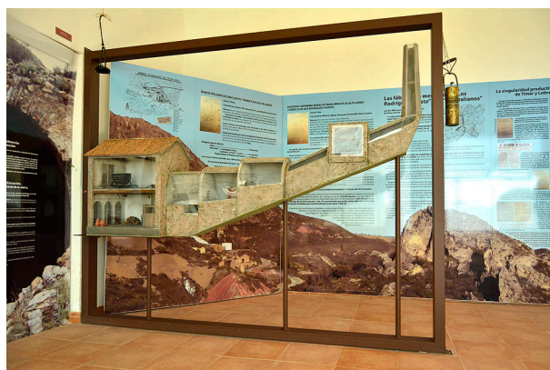
Imagen 99: Maqueta de una fábrica de beneficio de mercurio por condensación. Autoría propia.
