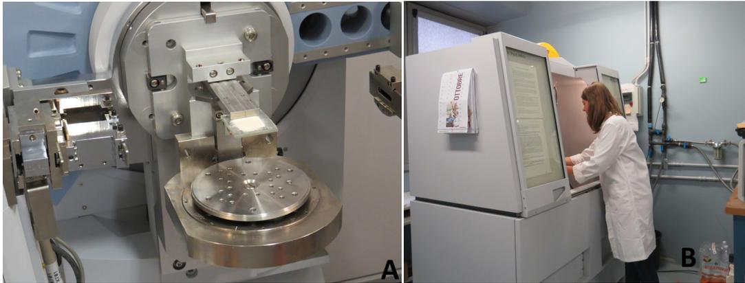
Figura 5. Análisis de piedra por DRX. Difractómetro X'Pert PRO PANalytical.
