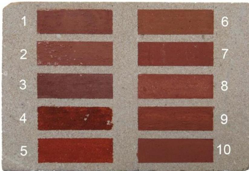
*Figura 6. Preparación de la probeta. Mezcla homogénea de las distintas arcillas procedentes de un radio de 70 km desde el yacimiento de Cerrillo Blanco, en agua. Los números describen la zona de muestreo: 1) Higuera de Calatrava, radio de 20km; 2) Higuera de Calatrava, radio de 20km; 3) Lopera, radio 20km; 4) Marmolejo, radio de 20km; 5) Marmolejo, radio de 20km; 6) Andújar, radio de 30km; 7) Alcaudete, radio de 20km; 8) Linares, radio 50km; 9) Linares, radio 50km y 10) Carboneros, radio 70km.*
