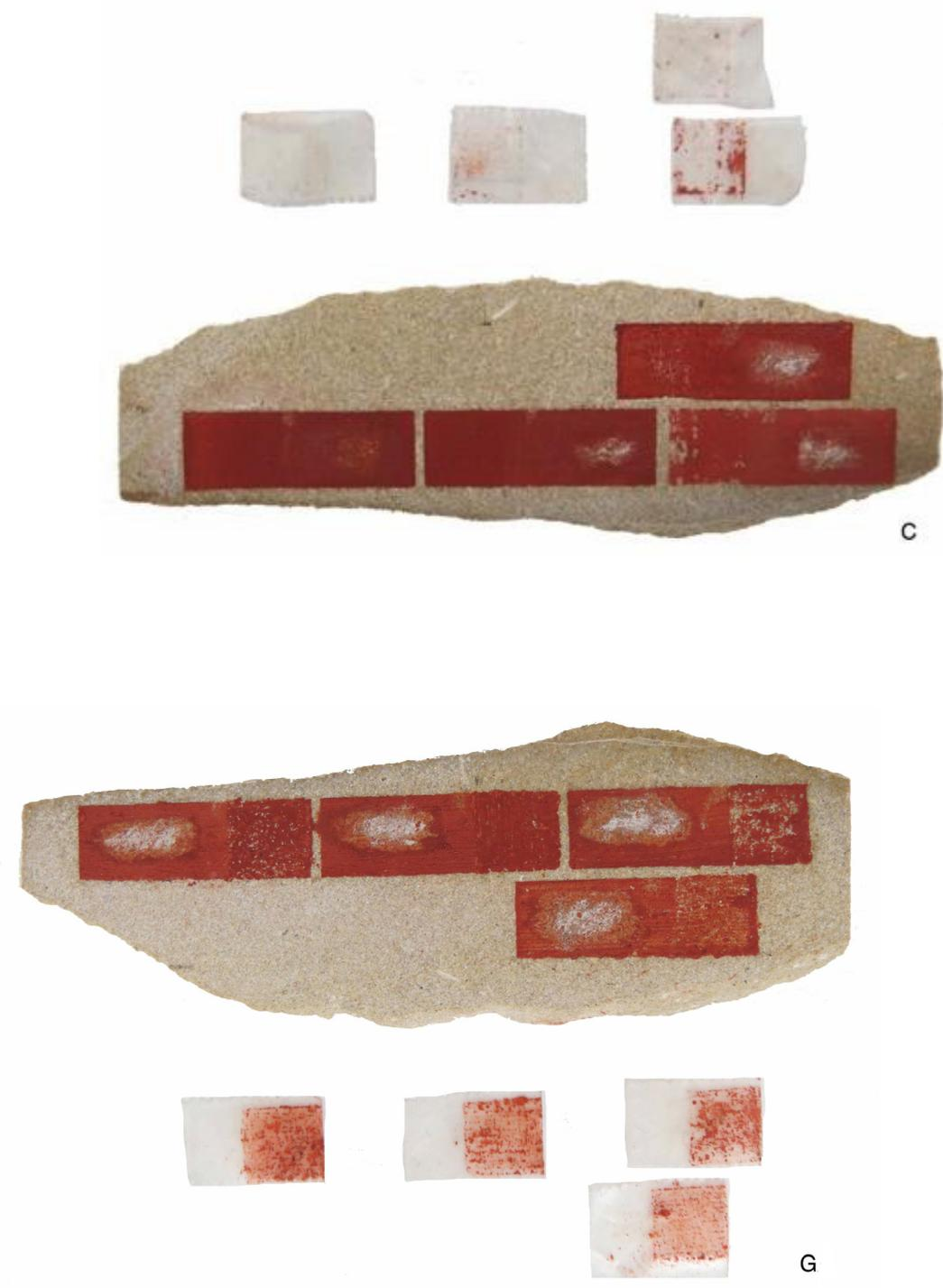
Figura 13. Ensayo de pelado en las probetas de tipo 2. Pigmento mezclado con aglutinante animal.
