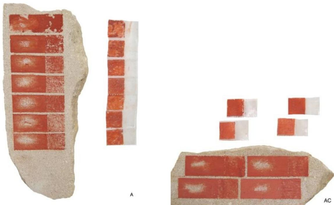
Figura 12. Ensayo de pelado en las probetas de tipo 2, grupo 1. Pigmento mezclado con agua y agua de cal.
