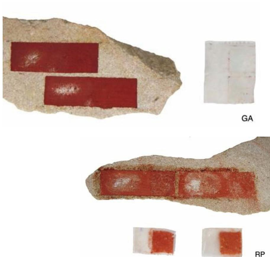
Figura 14. Ensayo de pelado en las probetas de tipo 2. Pigmento mezclado con aglutinante vegetal.
