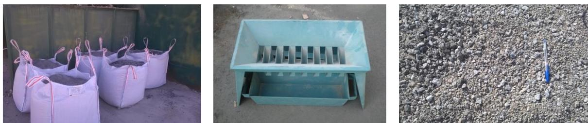
Figura 15. Material procesado para obtener las muestras de ensayo y reductor de muestras utilizado
