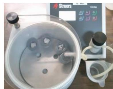
(c) Embutidora de vacío
