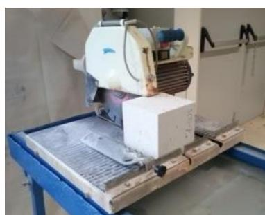
(a) Cortadora de sierra (probetas)
