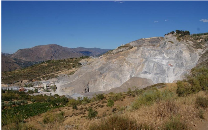
Canteras de áridos (dolomías trituradas, kakiritas) situadas en el cerro de las Colmenas (término de Pinos Genil), en las inmediaciones de El Purche. Foto propia, tomada el 17 de junio de 2017.
