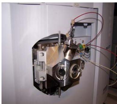
Figura 15. Interfase ESI utilizada en el acoplamiento HPLC-ESI-MS
