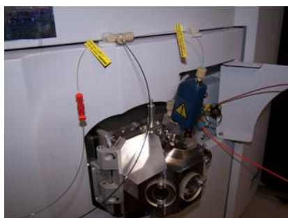
Figura 16. Interfase nano-ESI utilizada en el acoplamiento nano-ESI-MS
