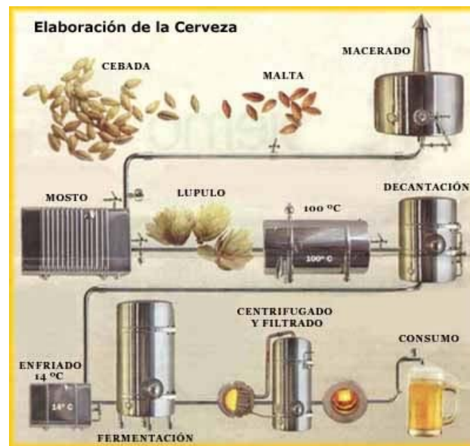
Figura 2 Diagrama del proceso de elaboración de la cerveza
