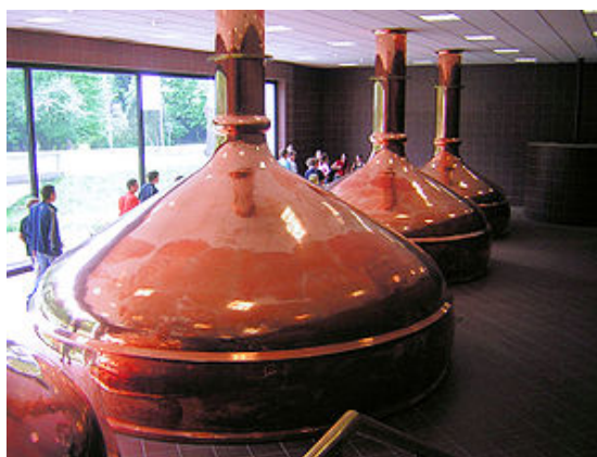
Figura 1. Tanques de cobre originales de cocción del mosto.
