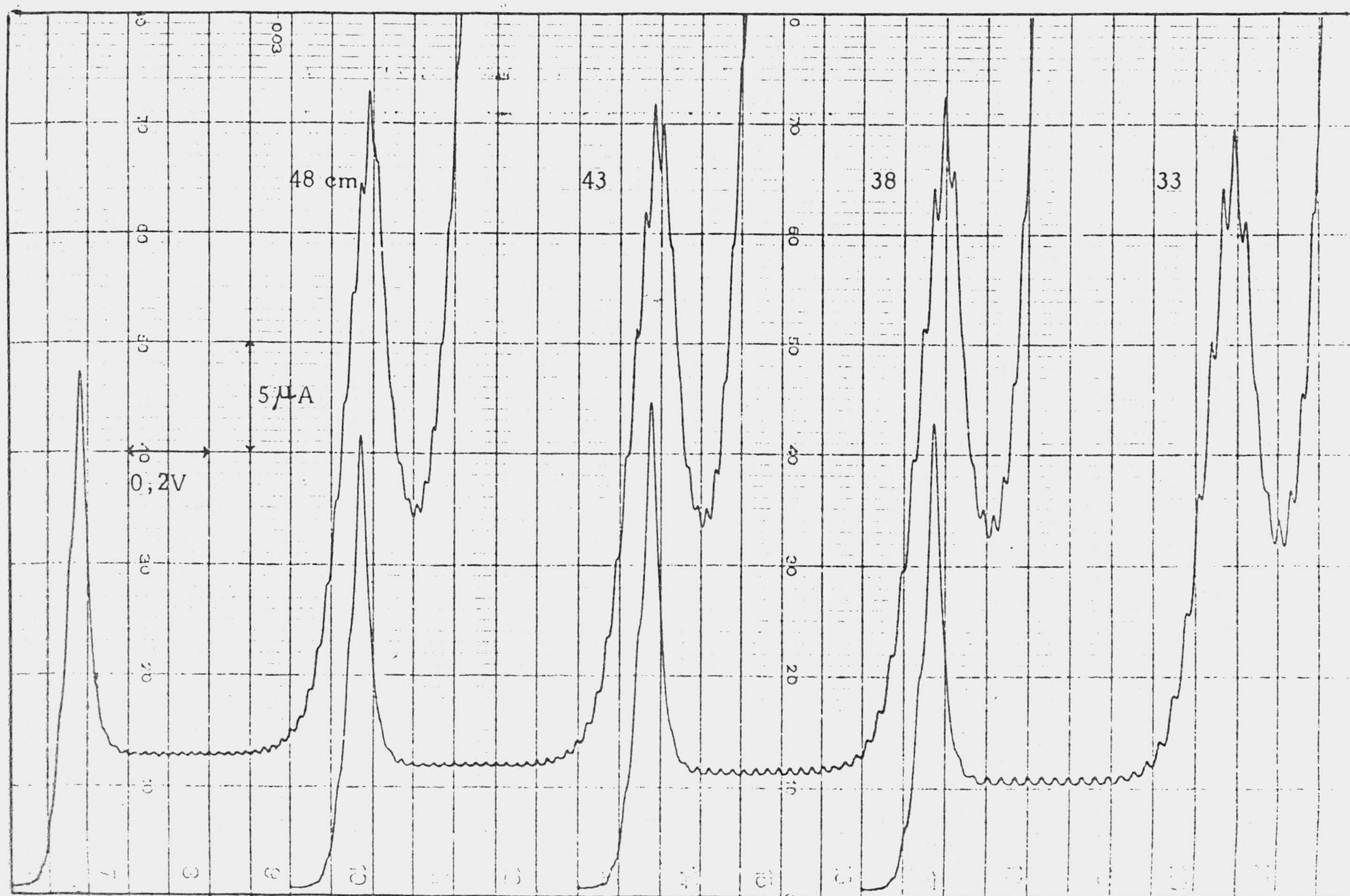
Fig. 47.- Polarogramas a diferentes alturas del depósito de mercurio en una disolución 10^{-3} M de (II) en amortiguador de Britton-Robinson. pH = 1,85. Origen -0,4V. T = 25°C.
