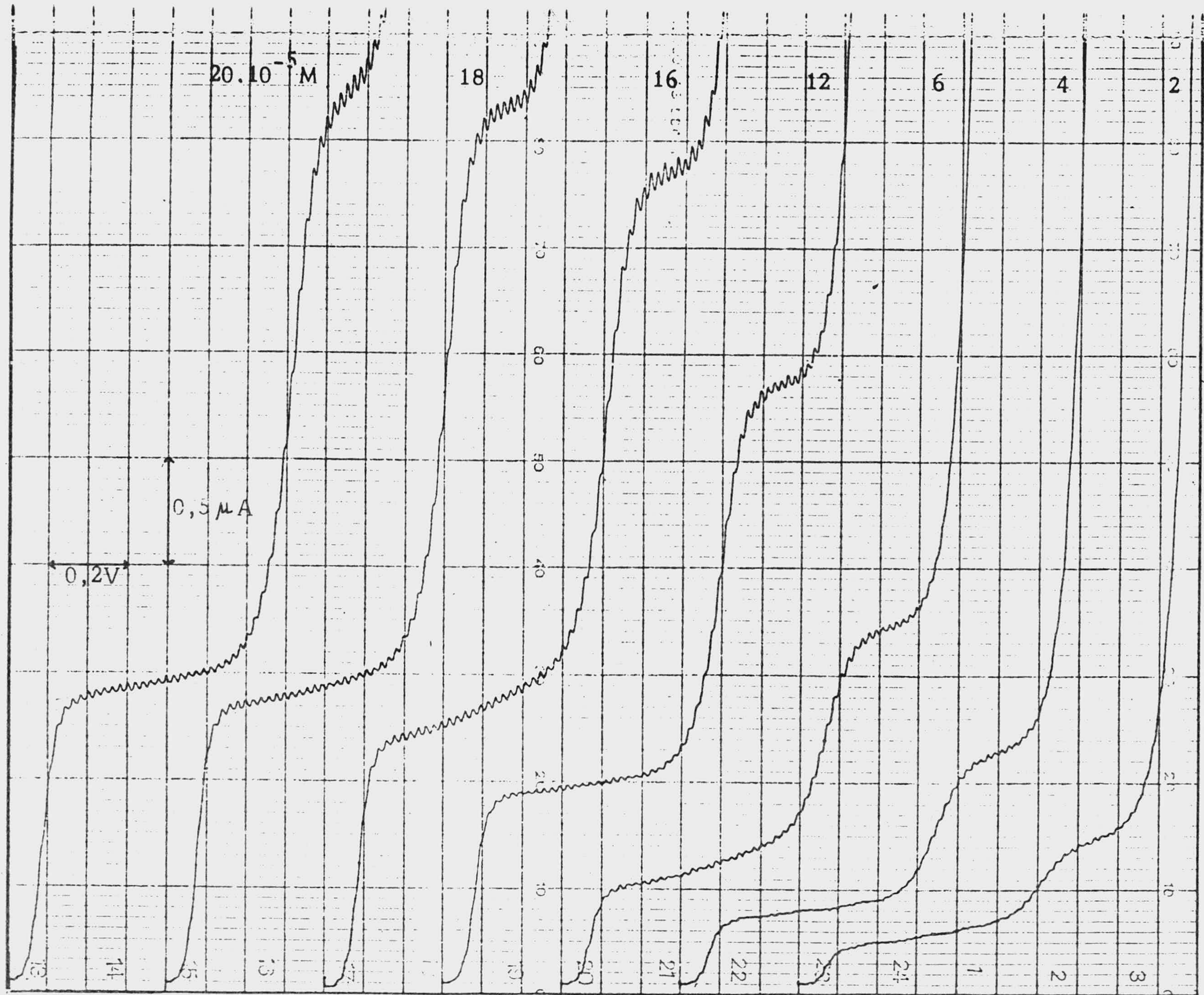
Fig. 39 .- Polarogramas de disoluciones de (II) de diferentes concentraciones en amortiguador de Britton-Robinson. \text{pH} = 1,85 . Origen -0,4\text{V} . h = 66 . T = 25^{\circ}\text{C} . v = 4\text{cm/min} . D = 6 .
