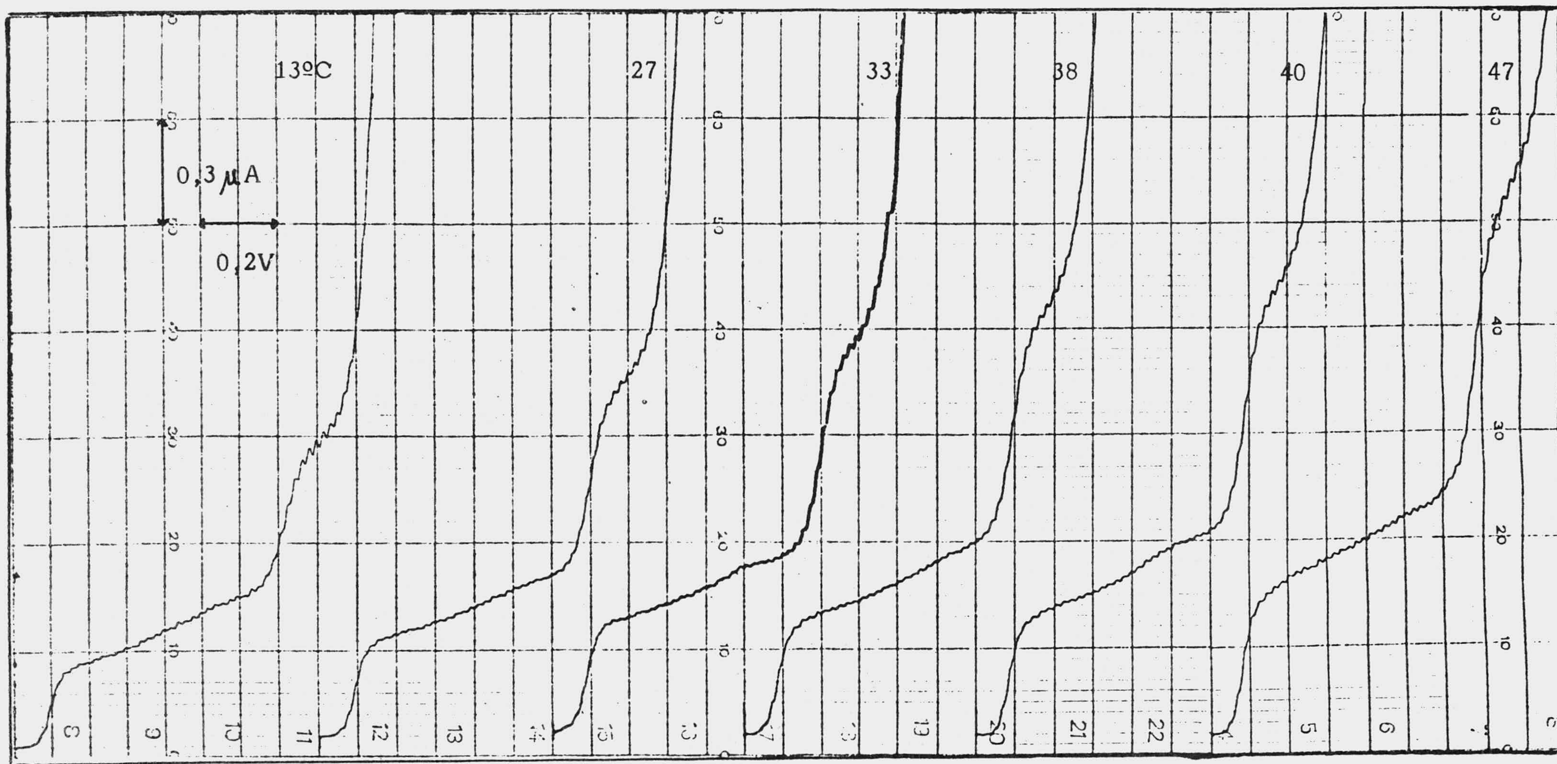
Fig. 27 .- Polarogramas correspondientes a una disolución de ( I ) 4 \cdot 10^{-5} M en amortiguador Britton-Robinson, pH = 1,98, a diferentes temperaturas. Origen -0,4V. h = 66 cm. D = 6. s.c. = 3 A. v = 4 cm/m.
