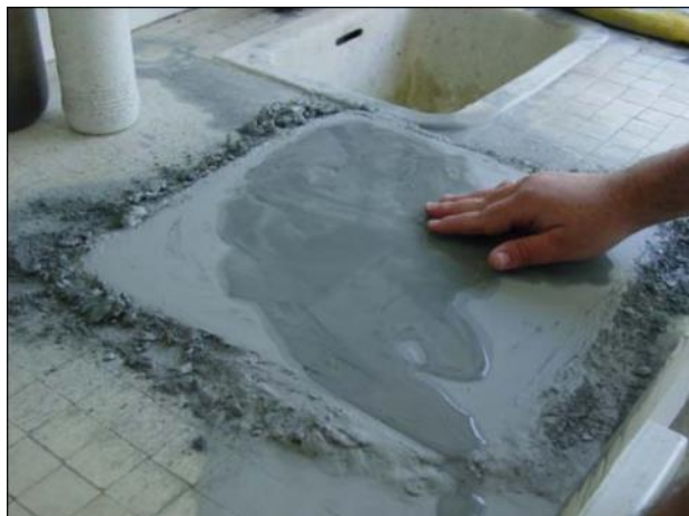
Figura 3.4. Pulimento manual de la lámina delgada.
