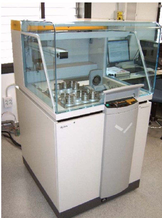
Figura 3.9.- Espectrómetro secuencial de rayos X de 4 KW de potencia, PHILIPS Magix Pro (PW-2440) disponible en el Centro de Instrumentación Científica de la Universidad de Granada.
