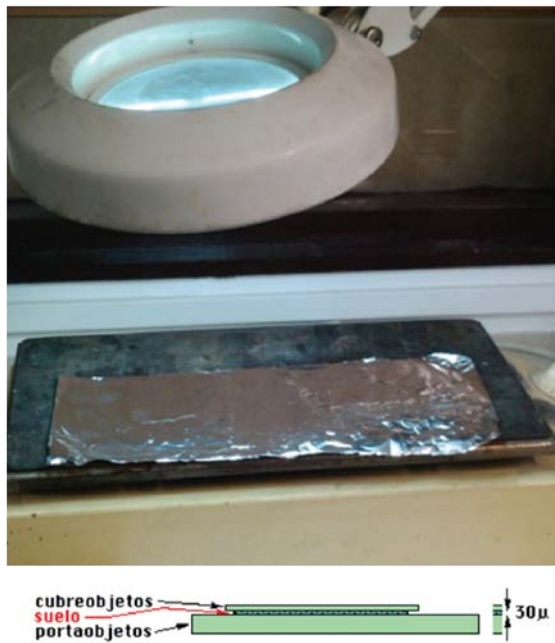
Figura 3.6.- Colocación del "cubre". Sección final de la lámina.
