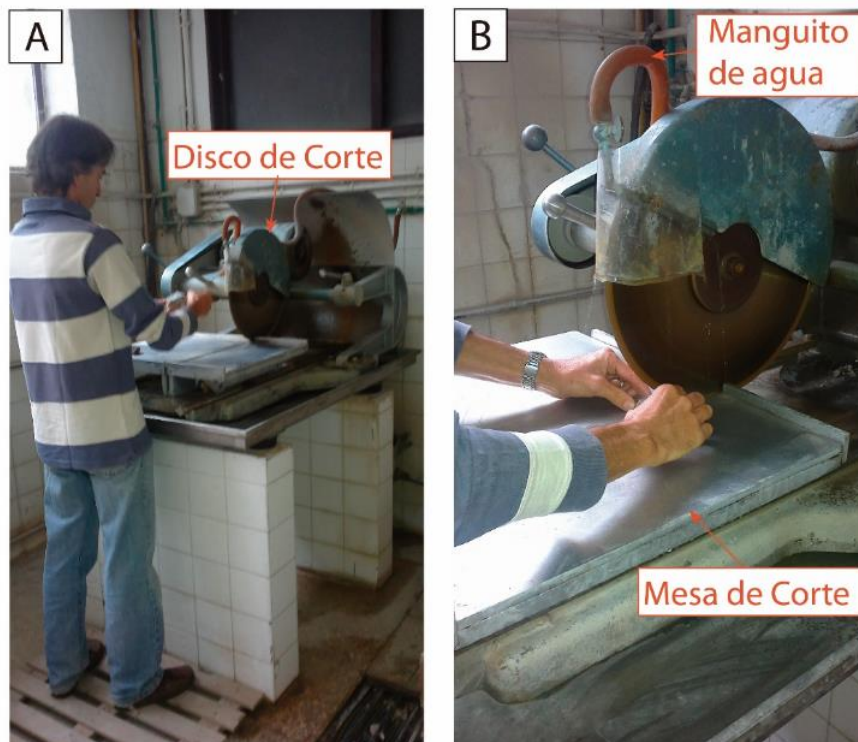
Figura 3.3.- A) Mesa de corte con disco en posición vertical. B) Detalle del disco refrigerado por agua.
