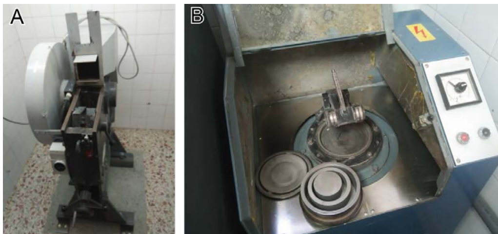
Figura 3.8.- Molino de mandíbulas (A) y de anillas (B) disponibles en el Dpto. de Mineralogía y Petrología de la Universidad de Granada.
