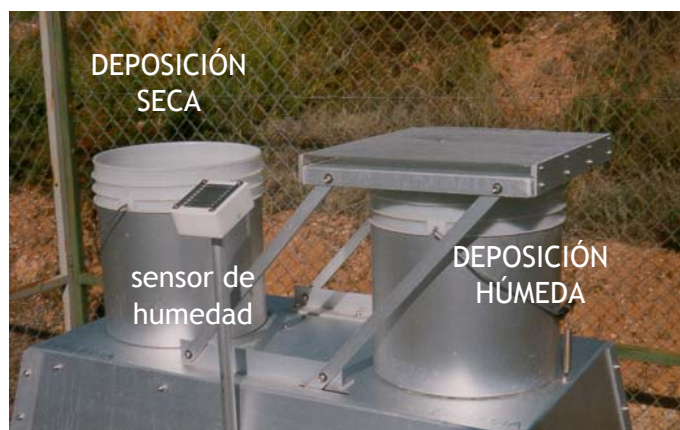
FIGURA M.1. Detalle de los componentes principales de un colector automático de deposición atmosférica seca y húmeda.
