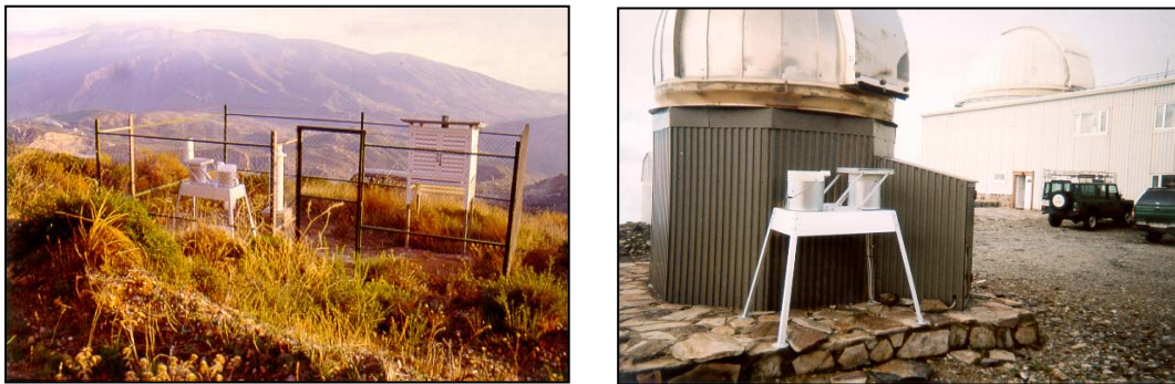
FIGURA I.1. Imagen de los colectores de deposición atmosférica situados en la localidad de Lanjarón (izquierda) y en el Observatorio de Sierra Nevada del Instituto Andaluz de Astrofísica (derecha).
