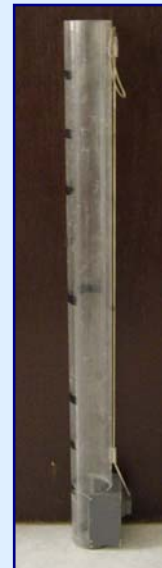
FIGURA M.2. Toma de muestras en la laguna de Río Seco y detalle de la columna de muestreo utilizada en esta laguna.
