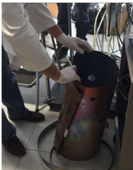
Figura 9. Lámina de deposición extraída para su limpieza (lijado)
