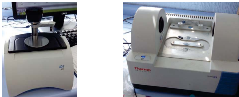
Figura 1. Equipo ATR-FTIR utilizado para llevar acabo los análisis de este capítulo. A la izquierda de la imagen se muestra el accesorio ATR.
