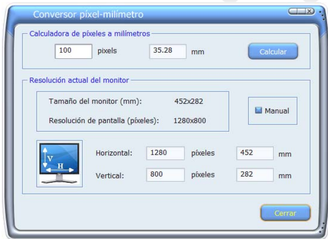
Figura 2.10. Ventana “Conversor píxel-milímetro”.
