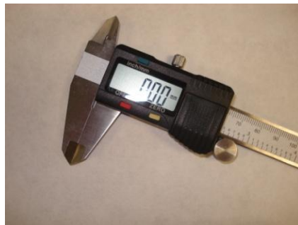
Figura 9. Calibrador para la medida de comprimidos y el espesor de los parches.
