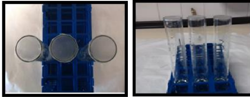
Figura 16: Tubos con las películas de los sistemas estudiados para el ensayo de permeabilidad al vapor de agua.
