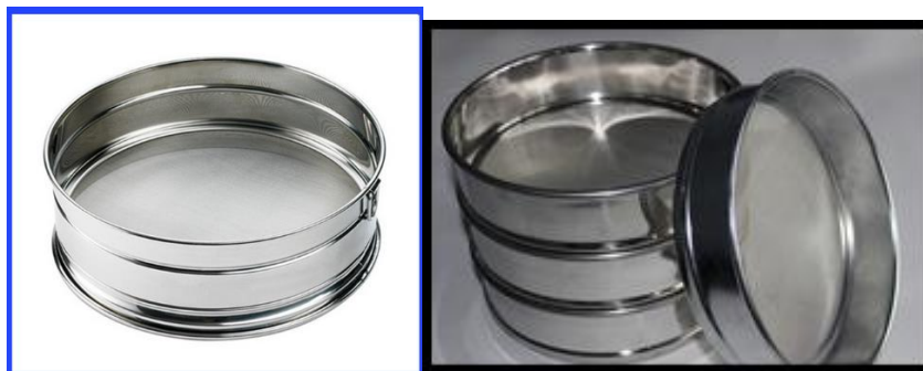
Figura 23. Tamiz utilizado para determinar la granulometría adecuada de los polvos.
