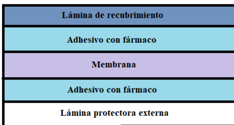
Figura 5. Esquema sistema terapéutico transdérmico multicapa.
