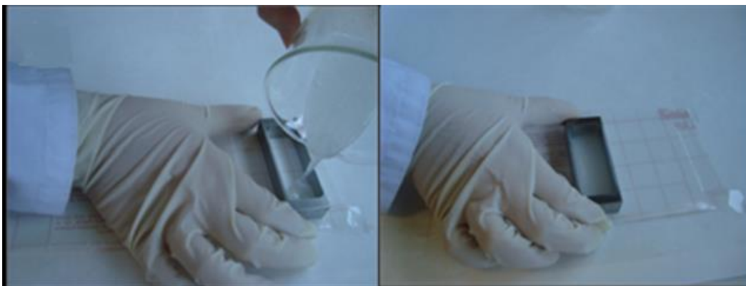
Figura 25. Proceso de laminación del parche.
