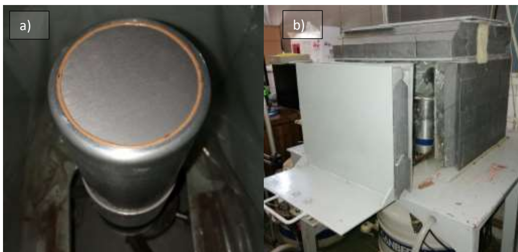
Fig. 7. Detector de Germanio usado para el análisis de este estudio, a) Lámina de berilio, b) Blindaje del Detector.
