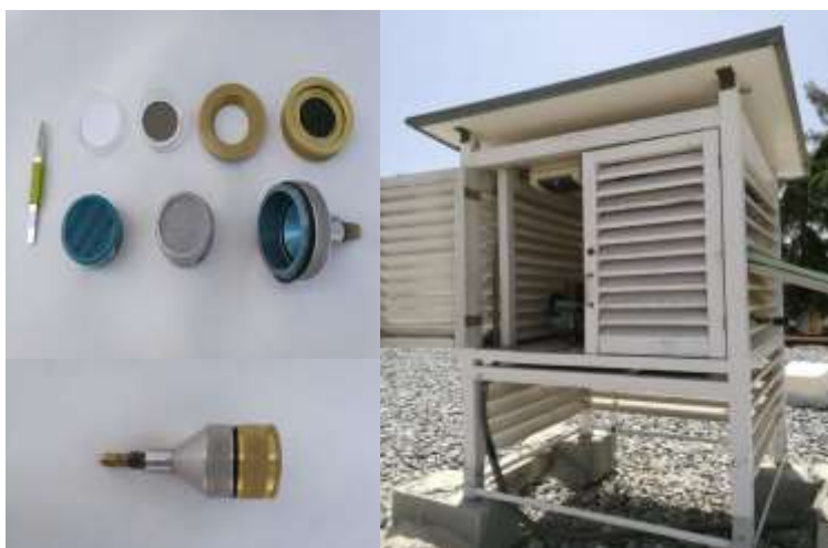
Fig. 2. Filtros y componentes del sistema de captación de aerosoles en la Facultad de Ciencias.
