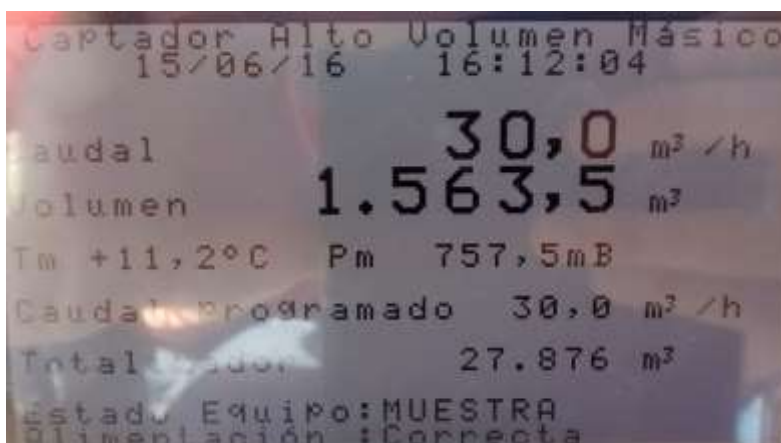
Fig. 3. Bomba de alto flujo usada por la captación de aerosoles en el Albergue de Sierra Nevada y los datos que presenta su pantalla.
