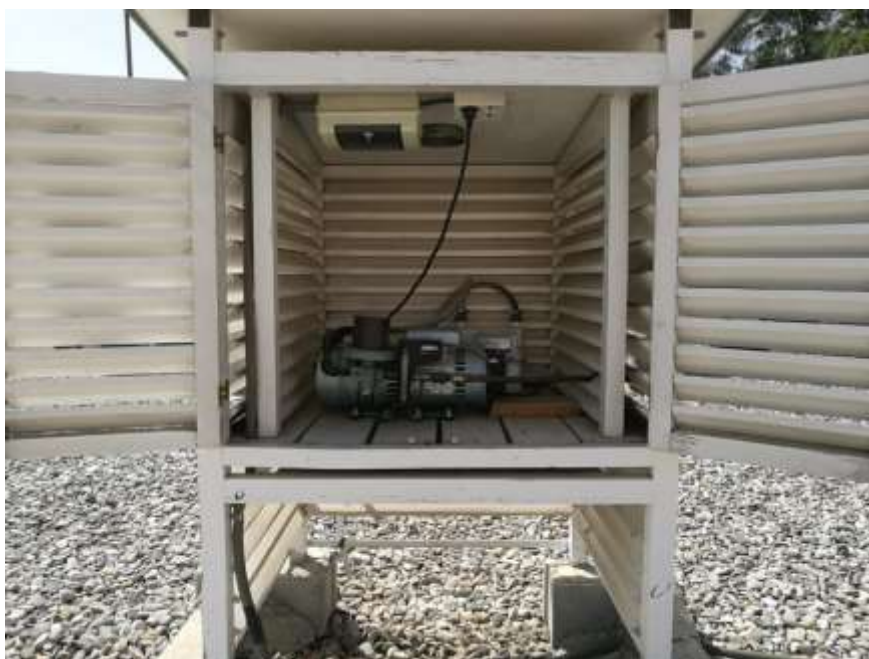
Fig. 1. Ubicación del equipo de captación de aerosoles AVS-60A
