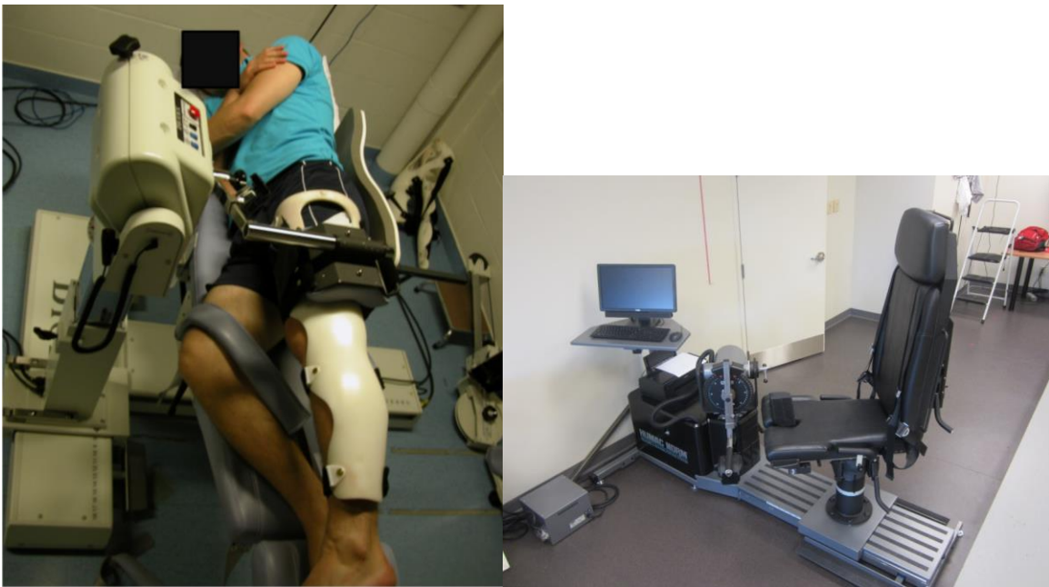
Figura 7, a la izquierda se observa la evaluación de la musculatura abductora de cadera con dispositivo isocinético y a la derecha otra marca de este mismo dispositivo.
