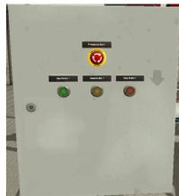
Figura 9.9: Modelo en 3D de la cuadro de control basado en botoneras.
