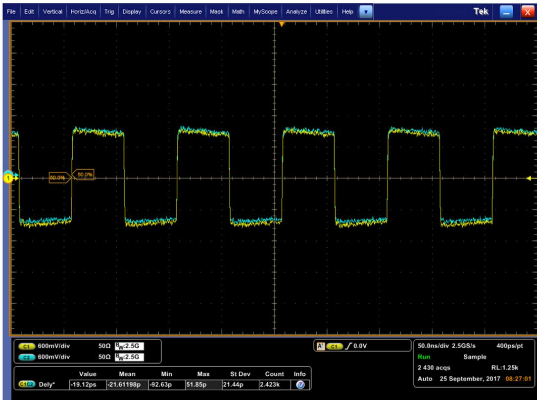
Figura 44: Salida de 10MHz desde dispositivos White Rabbit sincronizados con una precisión por debajo de un nanosegundo.
