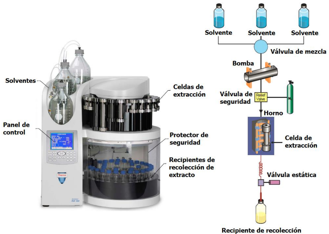
Figura 9.- Sistema de extracción con líquidos presurizados (PLE).
