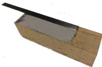
Figura 4.17. Ejemplo de la probeta L1-AHD1-2 con un fallo parcial de tipo C (70%) y modo A (30%).
