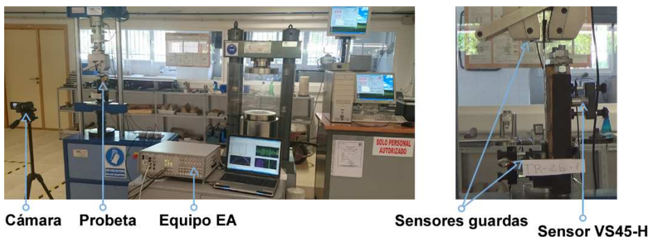
Figura 3.22. Configuración general de un ensayo pull-out . Izq.: Vista general. Der.: Imagen de la probeta y los sensores de EA.
