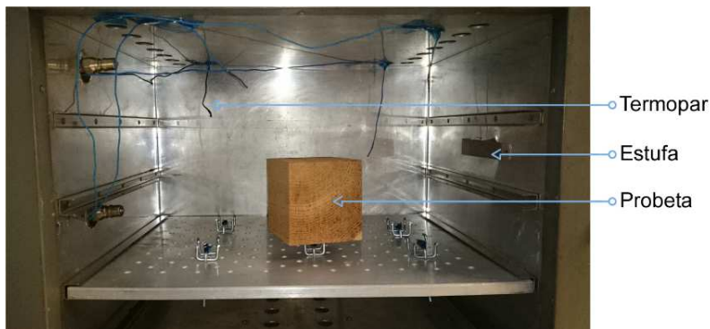
Figura 3.7. Probeta de madera colocada en la estufa antes del proceso de secado.
