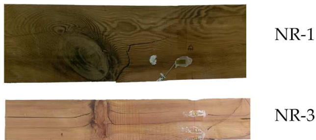
Figura 4.21. Imágenes de las roturas de las vigas del grupo NR. Arriba: NR-1. Abajo: NR-3.
