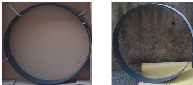
Figura 3.11. Imagen de los laminados empleados en esta Tesis. Izq.: SIKA Carbodur®. Der.: DRIZORO® COMPOSITE.
