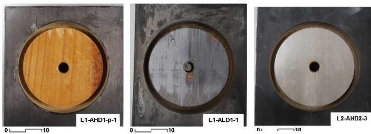
Figura 4.11. Imagen del fallo tipo C. Laminado de CFRP. Distancias en mm.
