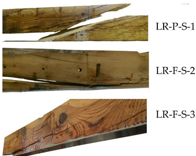
Figura 4.24. Imágenes de las roturas de las vigas del grupo LR. Arriba: LR-P-S-1. Centro: LR-F-S-2. Abajo: LR-F-S-3. Casa comercial: SIKA®.
