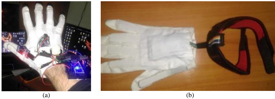
Figura 5. Versión primera del guante gestual (a) y versión final (b)
