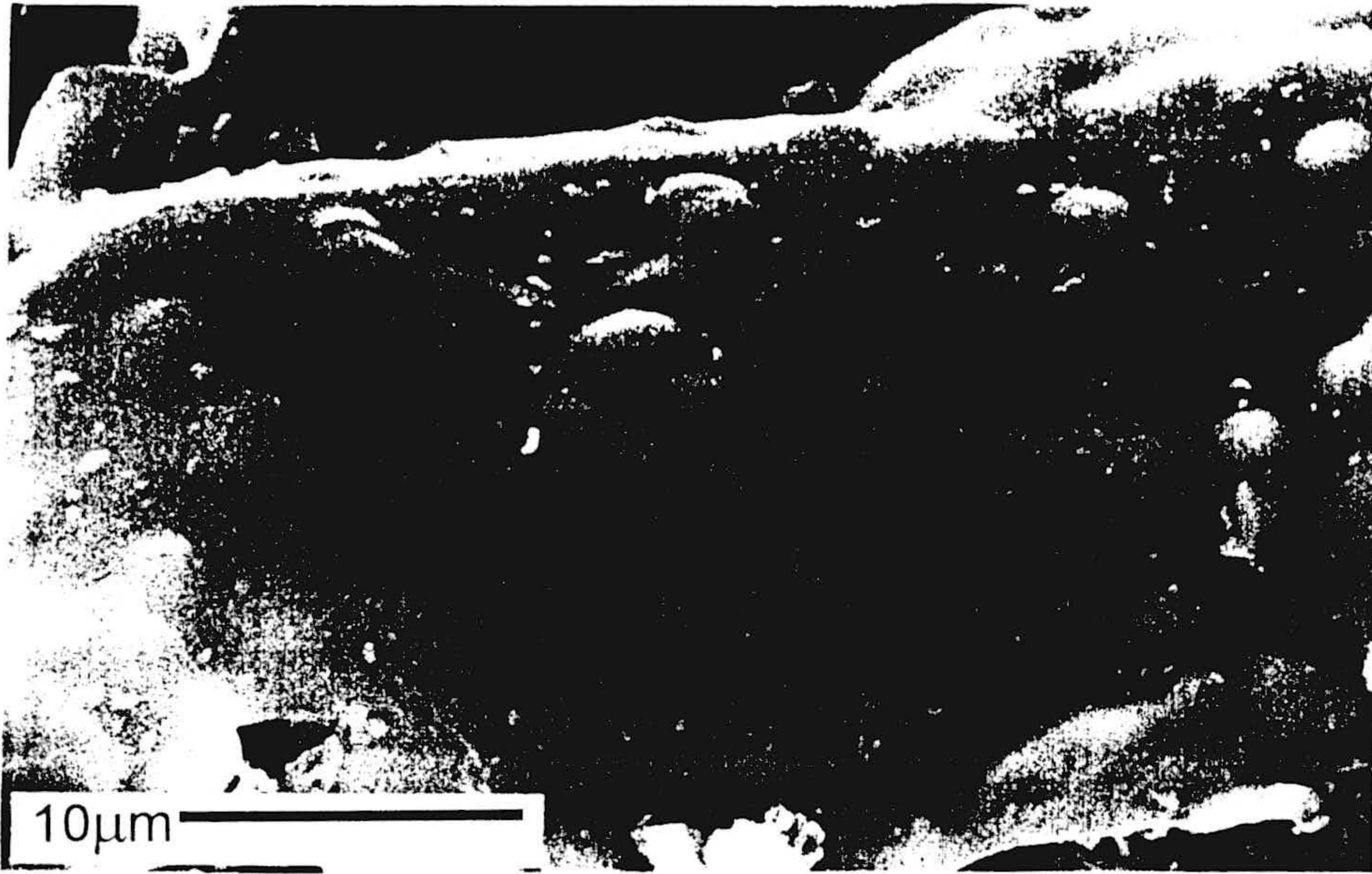
Figura III.26. Imagen de SEM correspondiente a una muestra alterada, mostrando las estructuras hemisféricas aparecidas sobre la superficie de los granos. Espectro EDS correspondiente a dicha superficie.
