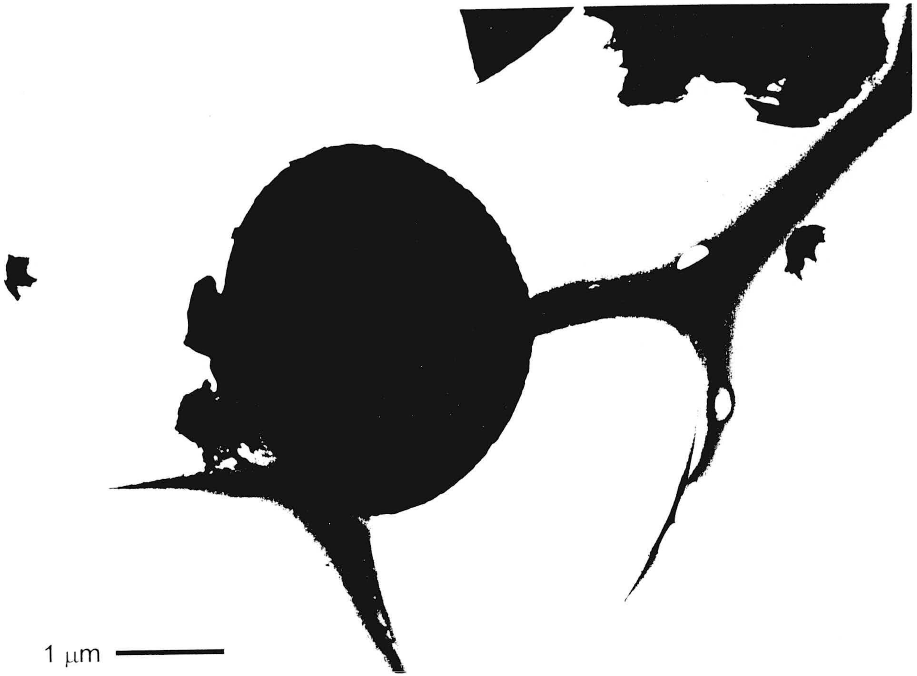
Figura III.36. Imagen de TEM de una muestra alterada. Grano con morfología de esfera de aproximadamente 4 \mu\text{m} de diámetro. Los análisis de AEM mostraban quimismo de S-I.
