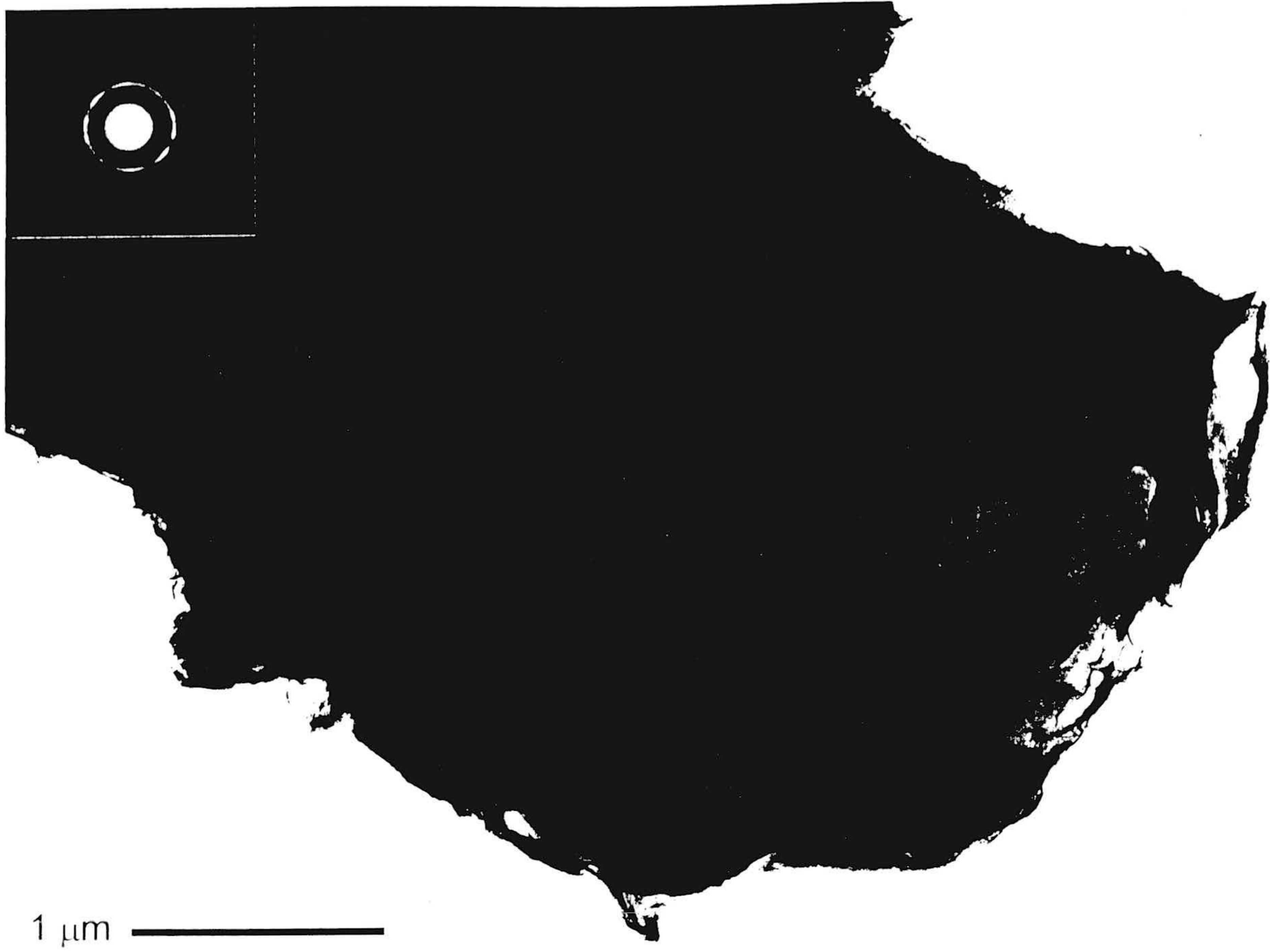
Figura IV.6. Imagen de TEM que muestra un grano de morfología de vidrio con quimismo y figura de difracción correspondiente a S-I.
