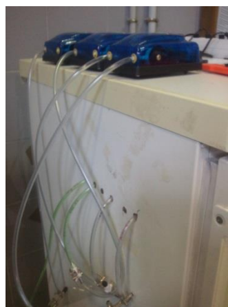
Ilustración 5. Disposición de bombas de aire.
