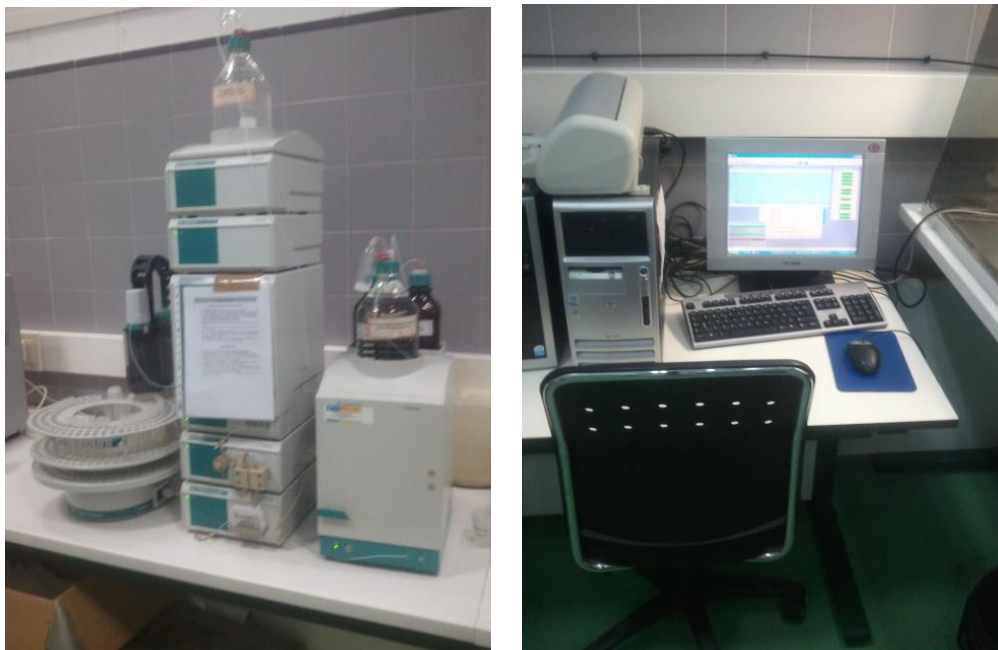
Ilustración 7. Cromatógrafo iónico utilizado en la determinación de cationes e iones.
