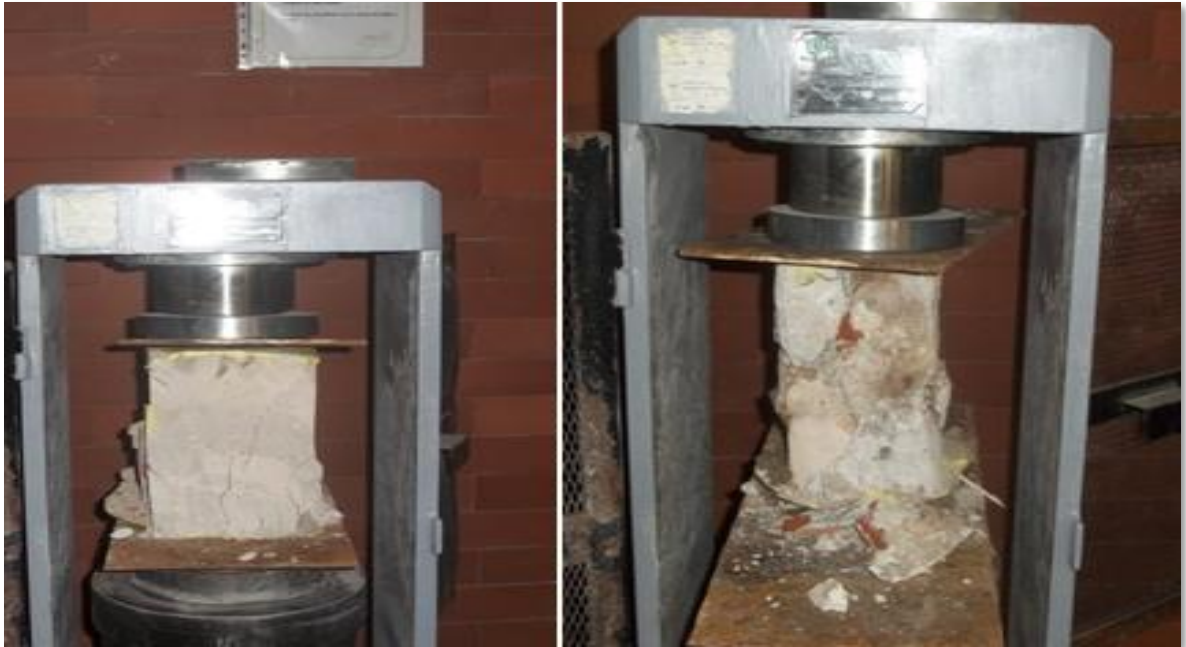
Ilustración 43. Ensayo a la compresión de muretes extraídos del antiguo edificio de la Gobernación de Bolívar, compuestos por piedra pomez, caliza y argamasa. Berrocal, A. (2013) [Fotografía]. Recuperado de “ Diseño y Reforzamiento Estructural del Palacio de la Proclamación. Antigua Sede de la Gobernación ”.
