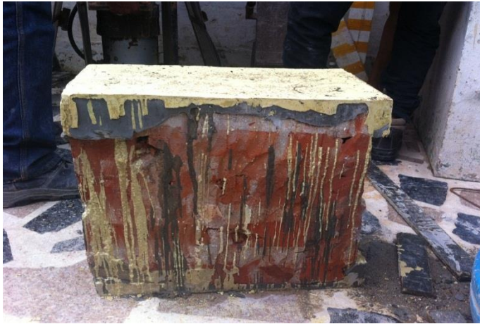
Ilustración 36. Esquema de muretes de ladrillo, según requerimientos del Reglamento NSR-10. Berrocal, A. (2017) [Fotografía e Ilustración]
