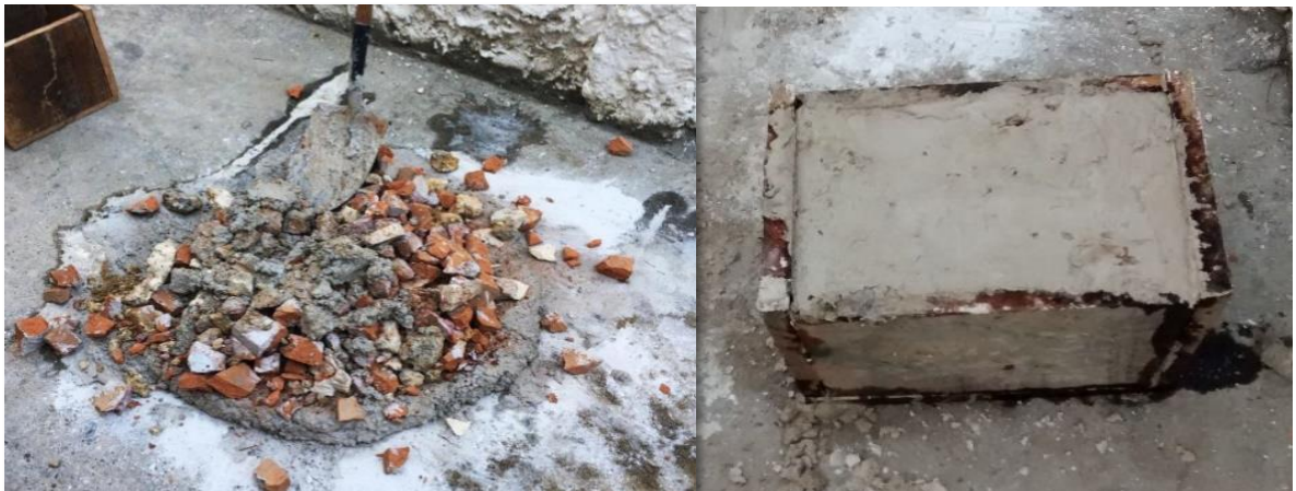
Ilustración 42. Muertes fabricados de acuerdo con los procedimientos descritos en la NSR-10, con fragmento de materiales recuperados de edificaciones correspondientes al periodo hispánico. Gamarra, J.; Camargo, A. (2016) [Fotografía]. Recuperado de “ Comparación de resistencias a la compresión entre mampostería colonial mixta presente en edificaciones y fortificaciones del centro histórico de Cartagena de indias, y muretes fabricados bajo criterios de construcción semejante ”.
