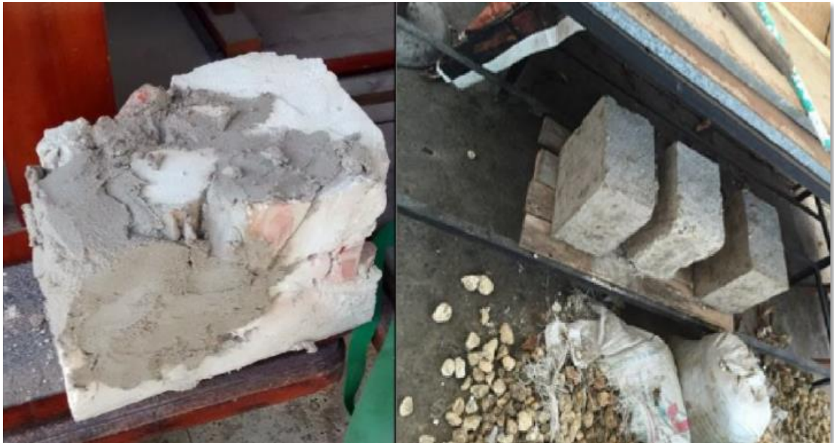
Ilustración 41. Murete extraído de casa construida en el periodo virreinal en el Centro histórico de Cartagena, pañetado con argamasa de cal y arena lavada en proporciones 1:2 respectivamente. Gamarra, J.; Camargo, A. (2016) [Fotografía]. Recuperado de “ Comparación de resistencias a la compresión entre mampostería colonial mixta presente en edificaciones y fortificaciones del centro histórico de Cartagena de indias, y muretes fabricados bajo criterios de construcción semejante ”.
