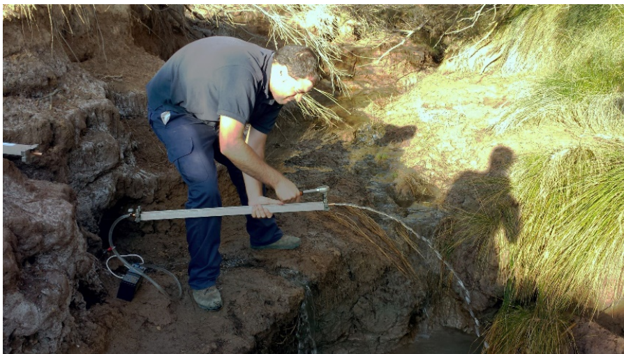
Figura 1.6. Muestreo de agua del manantial de Cañaveralejo (Antequera, Málaga) en tubo de cobre para la determinación de gases nobles (octubre de 2014)
