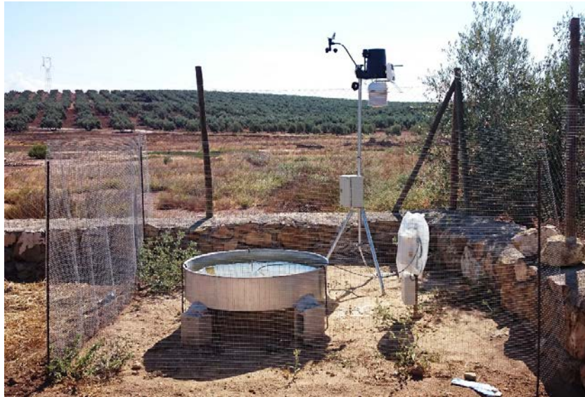
Figura 3.5. Estación meteorológica automática instalada en el Cortijo La Salina, con motivo de la presente investigación
