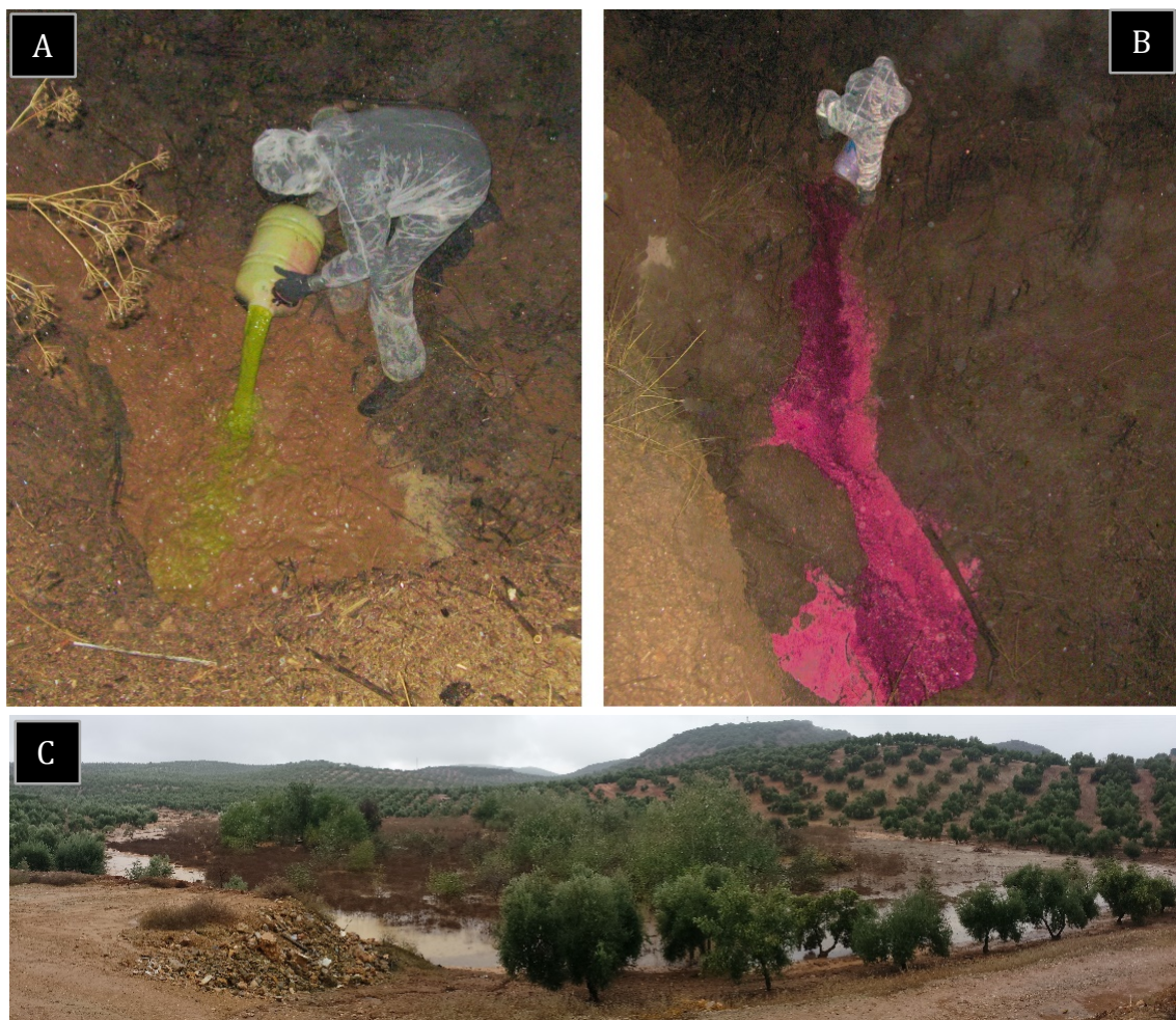
Figura 4.52. (A) inyección de URN en el sumidero IP1, junto al Cortijo de la Argamasilla; (B) inyección de SRB en IP2; (C) depresión en la que se sitúa IP1, con su fondo inundado
