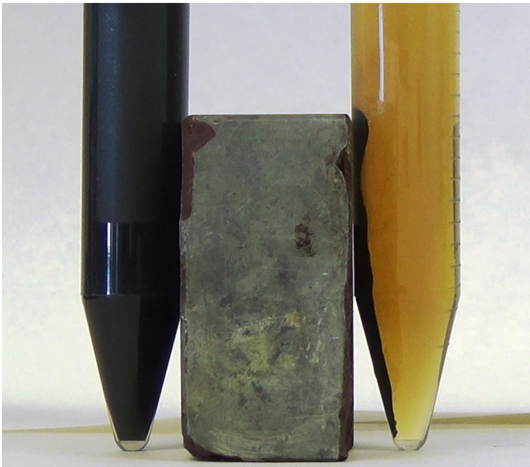
Figura 21. Fotografía del coloide formado por magnetita (izquierda) y por NPs magnetita/PEI (derecha) bajo la acción de imán de 400 mT (centro).
