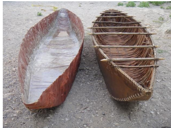
Imágenes de canoa acabada y carcasa o doble casco de poliéster
