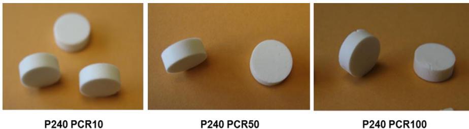
Figura 4.29. Comprimidos de PADAS/precirol® ATO 5 y DK-T sin tratamiento térmico después de 24 h de ensayo de disolución/liberación.
