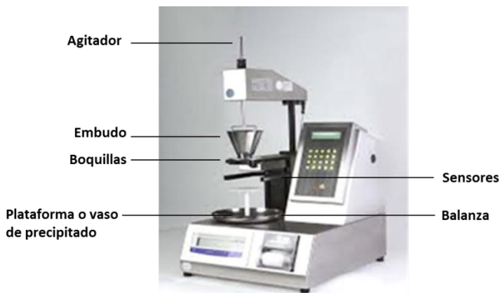
Figura 3.10. Dispositivo Pharma test modelo PTG-S3 para determinación de la velocidad de flujo y ángulo en reposo.
