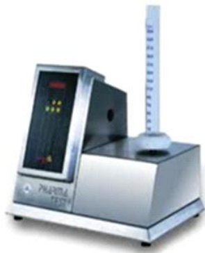
Figura 3.9. Dispositivo Pharma Test, modelo PT-TD 1 para determinación de volumen aparente.
