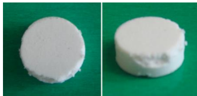
Figura 4.22. Comprimidos de PADAS/DK-T (DK-T P250) después de 24 h de ensayo de disolución.
