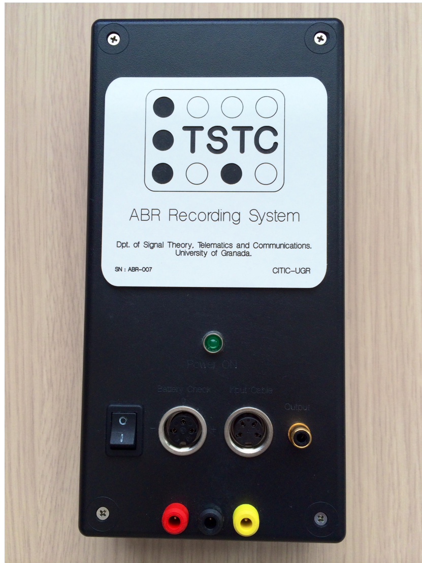
Figura 3.10: Fotografía del exterior de la unidad de amplificación.
