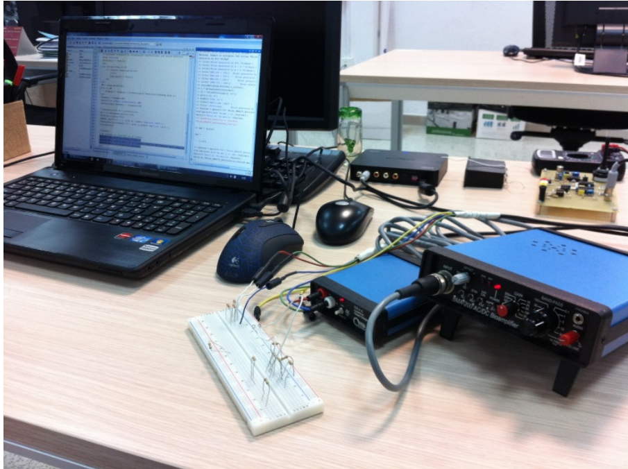
Figura 3.11: Imagen del proceso de análisis del rendimiento del amplificador BMA-200.
