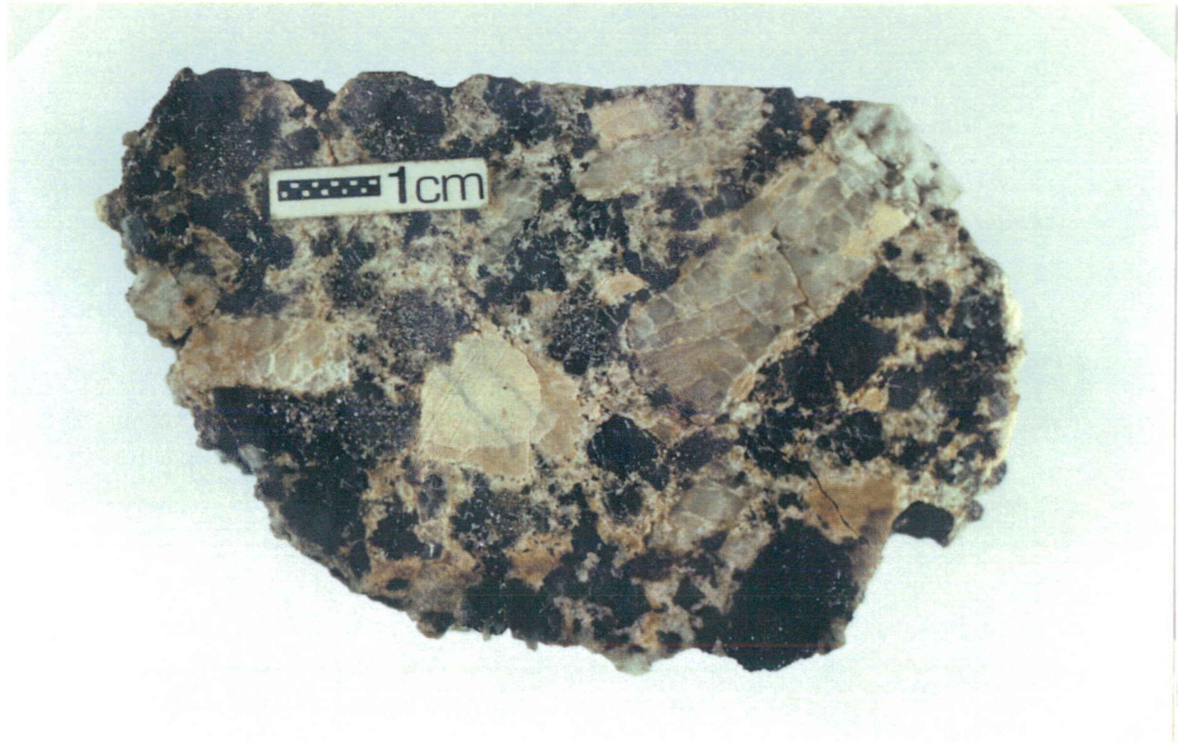
Foto 8. Metagranito porfidico con enclaves moscovíticos y biotíticos, Collado Monda. A pesar de que la textura ígnea se conserva, los minerales ígneos (a excepción del feldespato potásico) están reemplazados por minerales de origen metamórfico.
