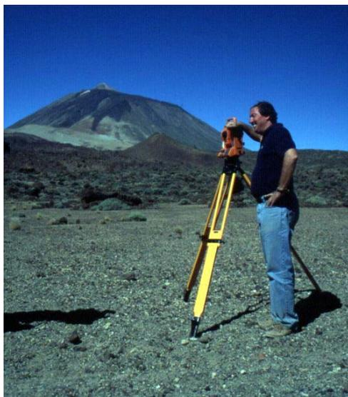
**Figura 4.3.** Posicionamiento de las estaciones mediante un teodolito.
