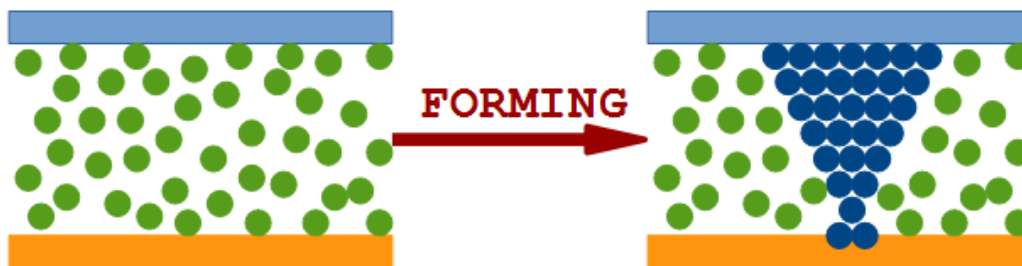
Figura 21: Representación esquemática de la operación de forming .
