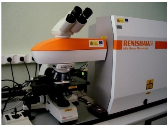
Figura 3.24 Equipo para análisis por espectroscopia Raman. Renishaw in Via microscope. Renishaw plc, Gloucestershire. UK. (Servicios Técnicos. Universidad de Jaén).
