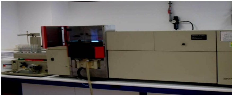
Figura 3.10 Equipo para análisis por espectroscopía de absorción atómica. Centro de Instrumentación Científica. Facultad de Ciencias. Universidad de Granada.
