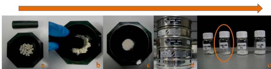
Figura 3.3 Proceso de obtención de la muestra pulverizada.
