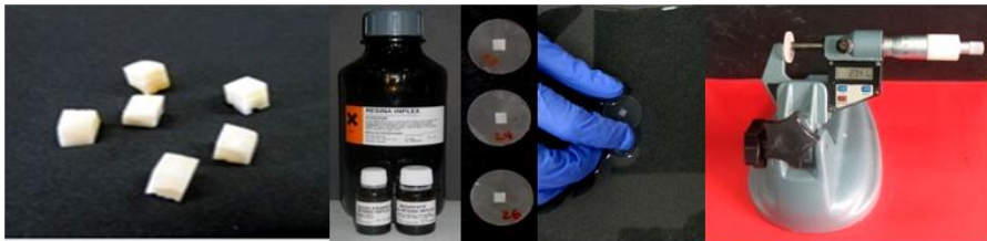
Figura 3.4 Montaje de muestras sólidas en discos de resina.
