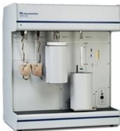
Figura 3.26 Equipo para análisis por Isotermas de adsorción. Analizador Micromeritics, ASAP 2020 acelerado de área superficial y porosimetría.
