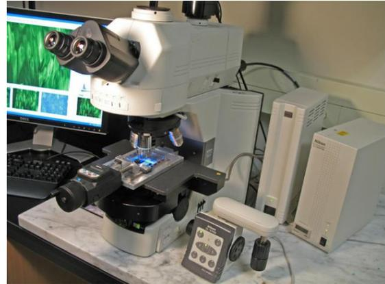
**Figura 3.4.** *Microscopio Nikon Eclipse 90i utilizado para la medida del espesor de la muestra.*
