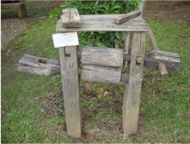
Viejo trapiche manual, generalmente empleado por mano de obra esclava. Ciudad de Guanare, Estado de Portuguesa (Venezuela).
