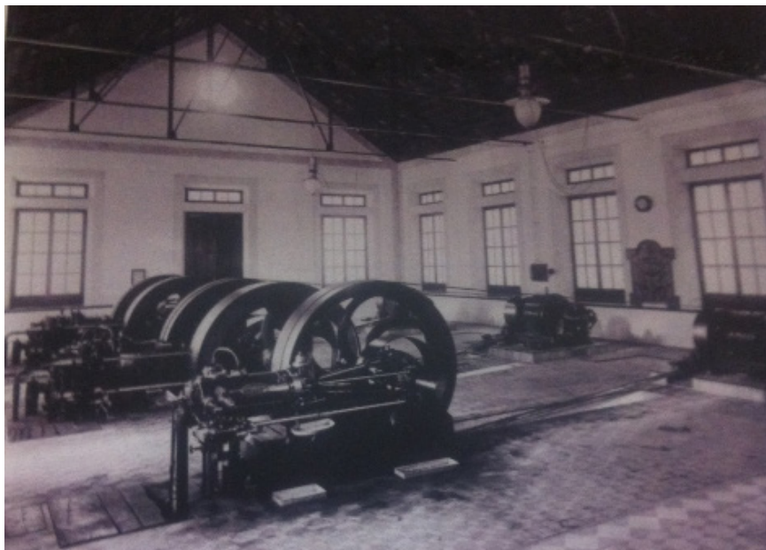
Nave de máquinas con motores a gas de la fábrica de pólvoras de El Fargue (1.908). La llegada de la Revolución Industrial a granada propició no sólo el auge de la industria azucarera, sino también de otras actividades económicas; Fotografía: anónimo.
