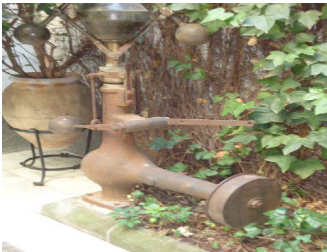
Válvula reguladora de velocidad de la Azucarera del Pilar. Archivo Miguel Giménez Yanguas. Foto: el autor.
