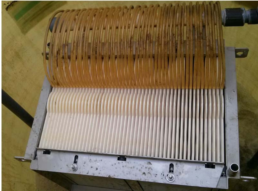
Figura 3.6: Módulo de membranas de microfiltración de la casa comercial KUBOTA
