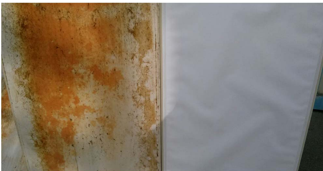
Figura 4.23: A la izquierda: membrana plana de microfiltración cambiada por ensuciamiento irreversible, a la derecha: membrana plana de microfiltración nueva
