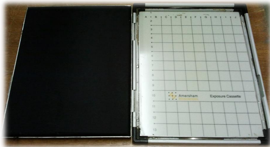
Imagen IV-3. Casete radiográfico de exposición a rayos-X donde se coloca una película fotográfica (Hyperfilm™ ECL, Amersham)
