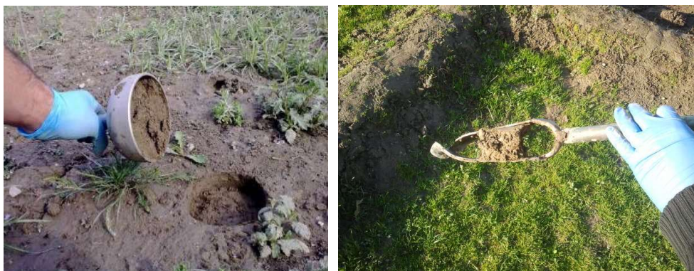
Figura III.4. Toma de muestra con muestreador de calado y barrena helicoidal
