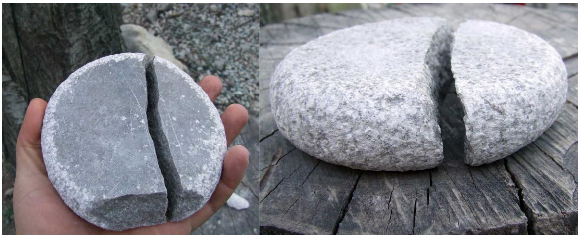
Fig. 230. Accidente experimental en el abujardado de una preforma de mármol
