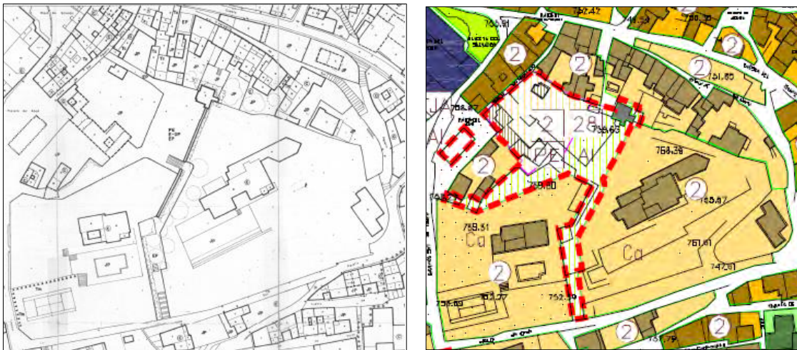
Fig.3.5.59: A la izquierda , detalle del AI-28 (S. Agustín) del PEPRI-1990 en el que se aprecia la apertura de viales que se propuso para conectar Cuesta del Chapiz, plaza del Abad y Carril de S. Agustín. Plano A-7_11 de Alineaciones y Ordenación del PEPRI-1990. Fuente: Archivo de planeamiento del Colegio de Arquitectos de Granada. A la derecha , detalle del AI-28 (S. Agustín), mantenido en 2001 sin cambios respecto a la ordenación prevista en el PEPRI-1990, extraído del Plano de Calificación y Usos (Hoja 21, escala 1/2000) PGOU-2001. Fuente: Servicio de Urbanismo del Ayuntamiento de Granada.
