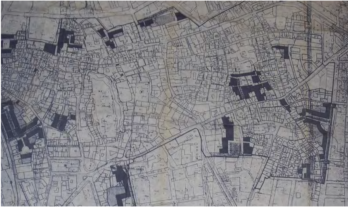
Fig. 2.4.03: PERICH-1990. Plano de Áreas de Actuación. El objetivo de Reforma interior frente al de la protección se hace evidente en este plano que refleja las propuestas de ordenación de nuevos volúmenes, apertura de nuevos viales y nuevos espacios públicos, fundamentalmente en los bordes del ámbito. Se echa en falta la delimitación de áreas de rehabilitación integral y de protección arqueológica. Fuente: Archivo de planeamiento. Colegio Oficial de Arquitectos de Granada.
