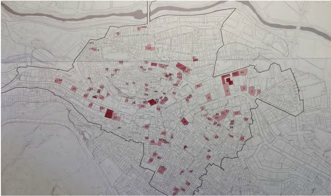
Fig. 2.8.07. Plano del Conjunto Histórico de Loja (solo la parte de la margen izquierda del río). En color las parcelas en las que se ha producido un exceso de alturas sobre el máximo nº de plantas permitido por las NNSS-1993. A los tonos más altos de color corresponden mayores excesos en altura. Fuente: “Análisis crítico sobre la rehabilitación arquitectónica en el Conjunto Histórico de Loja” . Proyecto de Fin de Grado de Laura Martínez García, tutorizado por el autor de la tesis. (2014).
