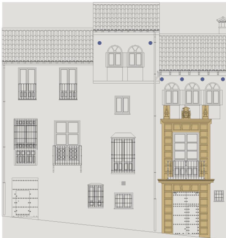
Alzado a la calle Zafra en el que destaca la portada manierista del nº 6 y el torreón del nº 8 que corona el módulo en el que se han resuelto los cuatro niveles de engalaberno sucesivo que han sido ganados para la parcela del nº 8. Arquitectos: Francisco Sánchez y Luis A. Martínez.
