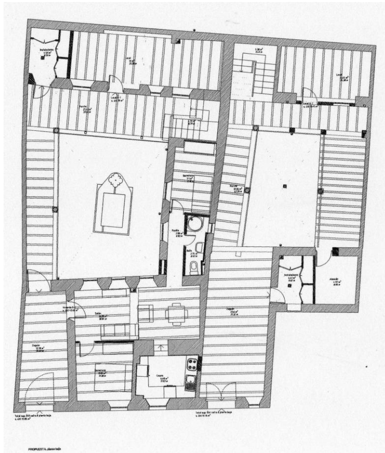
Planta baja. Distribución de zonas comunes y viviendas según el proyecto de rehabilitación Arquitectos: Francisco Sánchez y Luis A. Martínez
