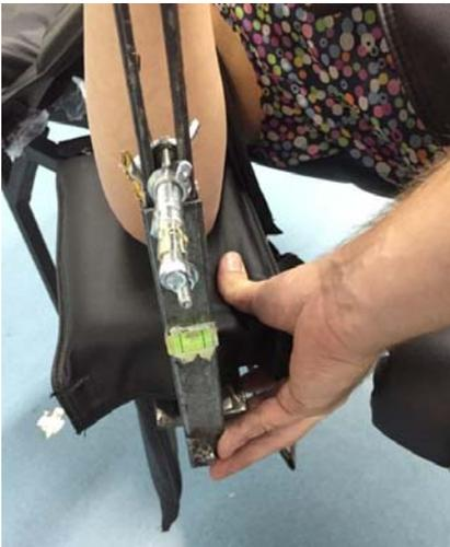
**Figura 29: Medición de la verticalidad del brazo de carga mediante un inclinómetro. Permite asegurar el ángulo recto entre el brazo de carga y el cable del EPD**
