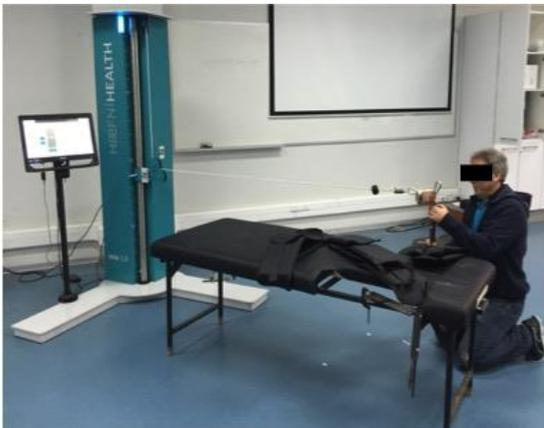
**Figura 23: Utilización del EPD Haefni Health 1.0 para evaluar la rotación lateral de hombro. La cuerda del EPD forma un ángulo de 90° con su brazo de palanca.**
