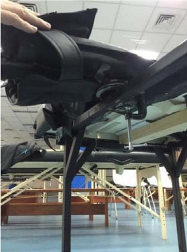
**Figura 24:** Sistema mecánico que permite modificar el ángulo de abducción de la articulación glenohumeral.
