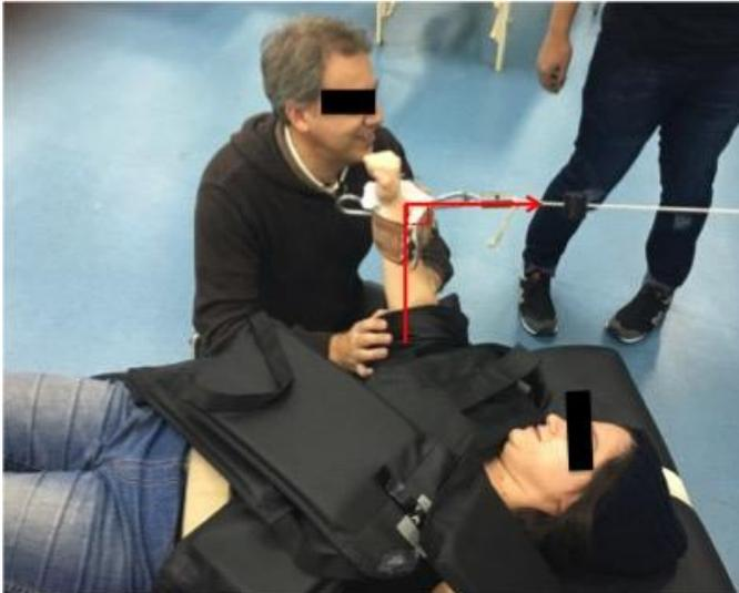
**Figura 19:** Posición inicial del sujeto en una prueba analítica de evaluación de fuerza muscular de rotadores mediales de hombro. Nótese al ángulo de  $90^\circ$  entre el segmento antebrazo que corresponde al brazo de palanca de la carga y la cuerda del EPD.
