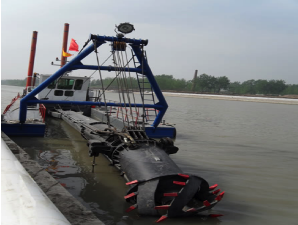
Figura 3.2: Draga de succión con cabezal cortador.
