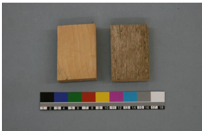
Figura 211. Soporte de madera para la elaboración de probetas. Se muestra la cara externa e interna de la madera.
