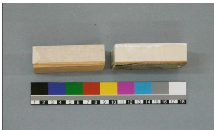
Figura 212. Protección de los cantos de la probeta previamente a la aplicación de la policromía.
