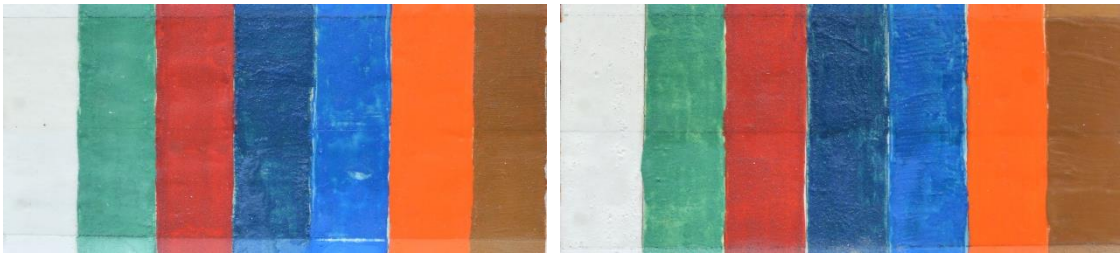
Figura 221. Izq. Particiones con tratamiento protector aplicado de probeta policromada realizada con aglutinante de huevo. Drch. Particiones con tratamiento protector aplicado de probeta policromada realizada con aglutinante de goma arábica. En ambos casos se puede apreciar visualmente que no hay crecimiento de las especies inoculadas.
