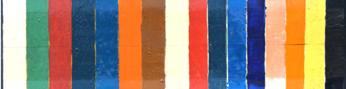
Figura 222. Particiones con tratamiento protector aplicado de probeta policromada realizada con aglutinante de aceite. Igualmente, se puede apreciar de forma visual que no hay crecimiento de las especies inoculadas.
