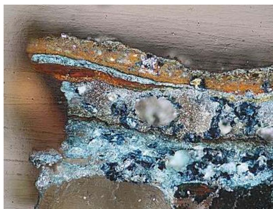
Figura 95. Muestra PD.M.148 con tinción de negro Amido II, reactivo que indica la presencia de proteínas. Imagen de microscopía óptica a 300 X.
