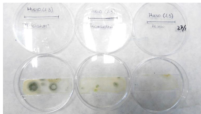
Figura 225. Portaobjetos con aglutinante de huevo, contenidos en cajas de Petri, inoculados previamente con esporas ( 10^6 esporas /ml) de Trichoderma y Penicillium .
