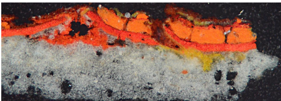
Figura 210. Estratos de repolicromado de la línea roja de bandera donde aparece contaminación de sisa procedente de la línea dorada colindante. Muestra PD.M.3. MOP. 10X
