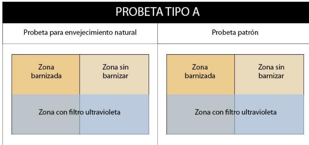
Figura 40. Esquema representativo de la estructura que presenta la superficie de las probetas patrón y las destinadas a envejecimiento, tras la aplicación sucesiva del barniz identificado en la policromía del alfarje y el filtro ultravioleta.
