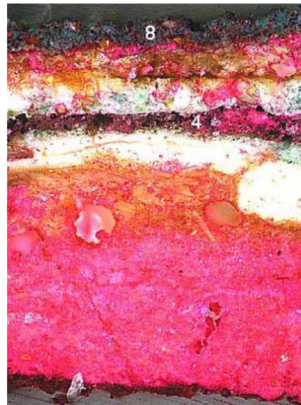
Figura 103. Muestra PD.M.20 con tinción de Fuchsin, reactivo que indica la presencia de proteínas. Imagen de microscopía óptica a 200 X.
