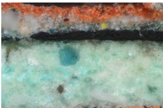
Figura 188. Estrato de azurita alterada convertida en hidroxicloriguro de cobre sobre de que se aplica una mezcla de pigmentos en la intervención posterior con la intención de imitar esta tonalidad. Muestra PD.M.134. MOP 50X
