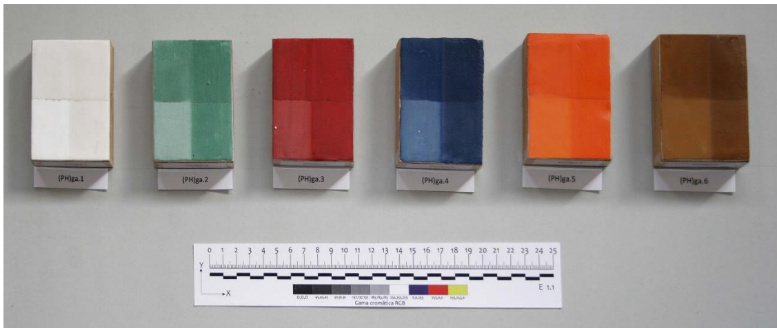
Figura 215. Probetas elaboradas con materiales históricos. Aglutinante de goma arábica.
