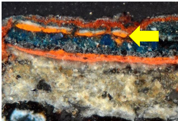
Figura 187. Estrato rojo de color de fondo duplicado correspondiente a una subsanación. Muestra PD.M.92. MOP 20X
