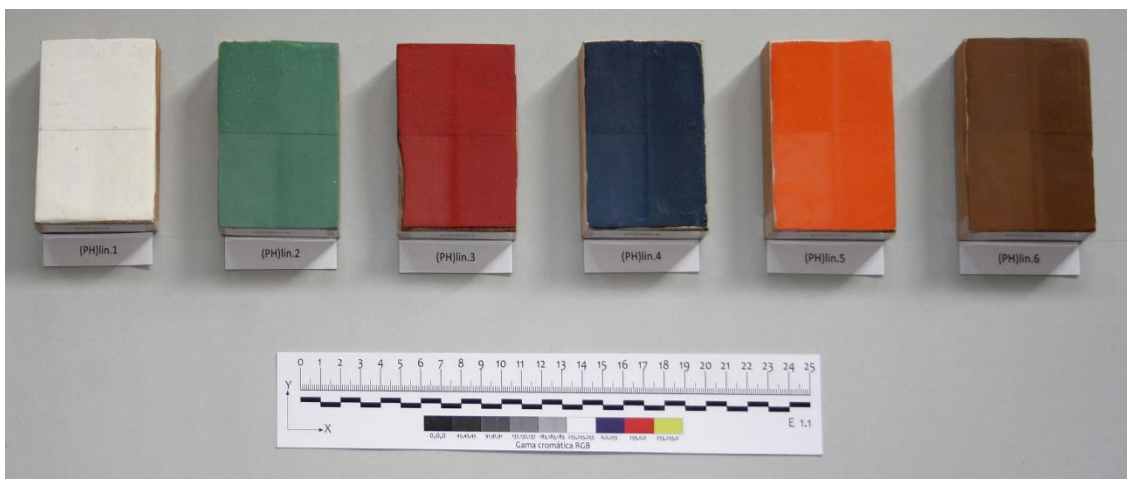
Figura 216. Probetas elaboradas con materiales históricos. Aglutinante de aceite de linaza.
