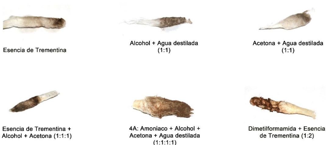
Figura 56. Resultado de los hisopos tras la realización de los distintos solventes en la superficie policroma
