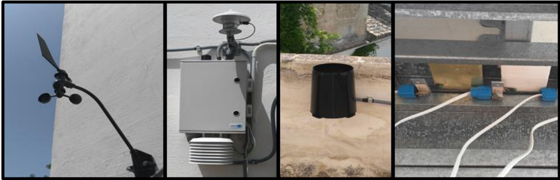
Figura 42. En orden de aparición en la imagen: 1. Aerómetro. 2. Sensor UV, Piranómetro y sensor de humedad y temperatura con campana anti-radiación. 3. Pluviómetro. 4. Sondas cableadas que miden la humedad y temperatura superficial de cada probeta.
