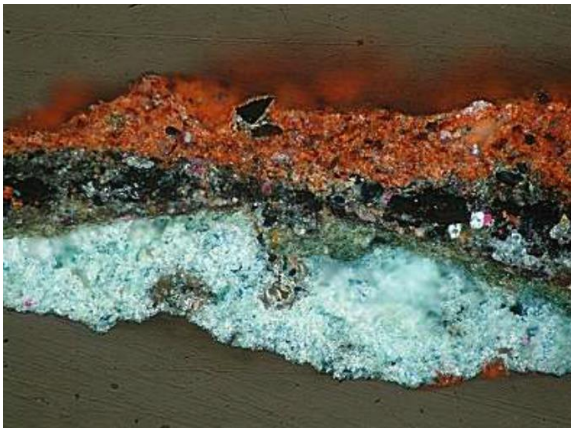
Figura 84. Muestra PD.M.10 con tinción de negro Amido II, reactivo que indica la presencia de proteínas. Imagen de microscopía óptica a 300 X.
