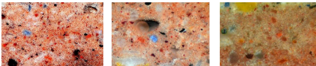
Figura 194. Detalle de capa de preparación con matriz distinta correspondiente a las muestras tomadas en el paramento sur. Muestras (en orden de imágenes MOP) PD.M.112, PD.M.160, PD.M.165.
