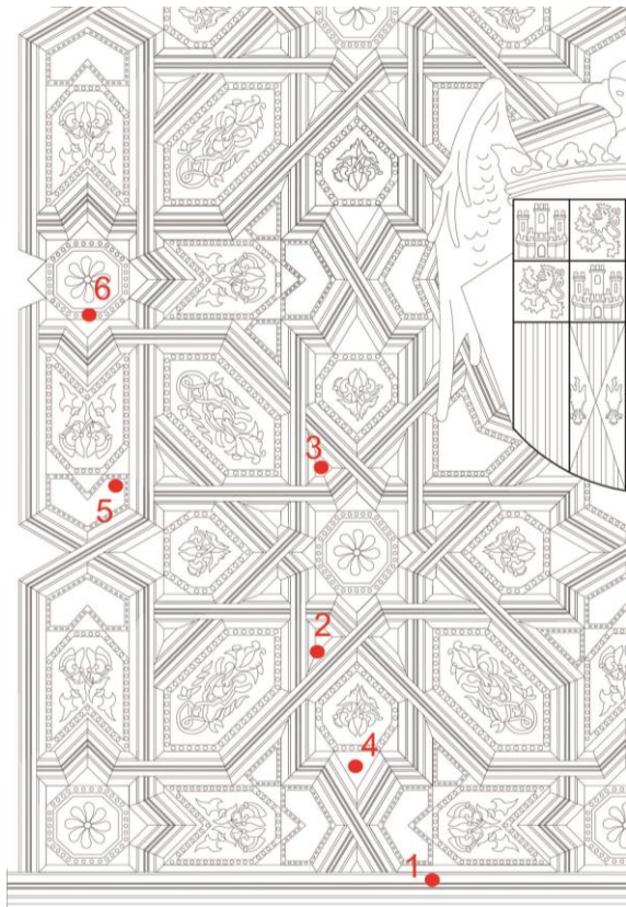
Figura 48. Mapeo de muestras tomadas correspondientes a zonas con un alto contenido en hongos.
