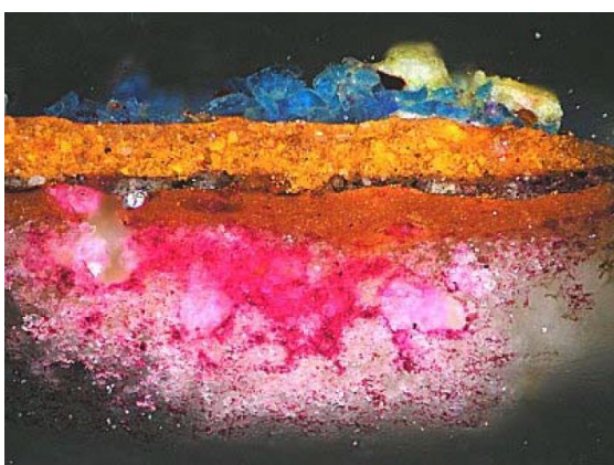
Figura 175. Muestra PD.M.7A con tinción de Fuchsin, reactivo que indica la presencia de proteínas. Imagen de microscopía óptica a 300 X.
