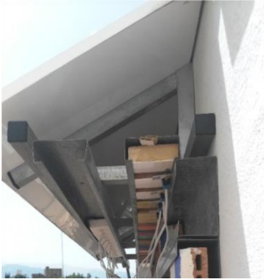
Figura 41. Estructura donde se disponen las probetas para envejecimiento natural.
