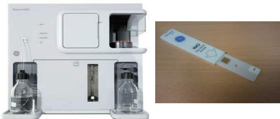
Figura 1. Aparato de SPR Biacore™ y chip CM4
