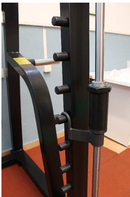
Figura 24. Tope mecánico en el pórtico guiado para la realización de los ejercicios de sentadillas
